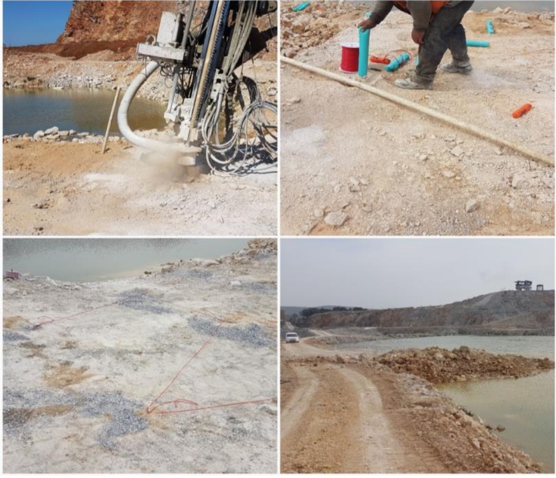
Şekil 5.11: Patlatma Bölgesi-1 (Delme, Şarjlama, Bağlantı ve Patlatma Sonrası Fırlayan Taşlar).
