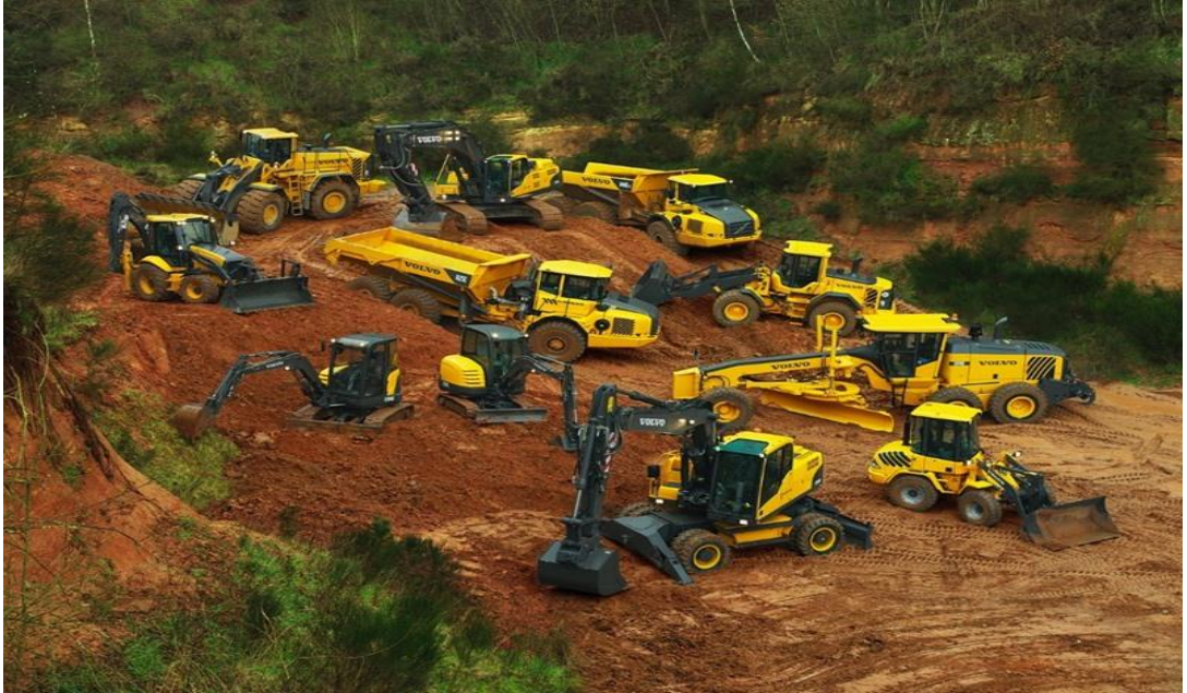
Şekil 3.4: Maden Çalışmalarında Kullanılan İş Makinalarının Bir Kısmı (Loader, Paletli Ekskavatör-Kırıcı, Kepçe, Lastikli Ekskavatör, Greyder, Mini Ekskavatör, Kamyonlar). [14].
