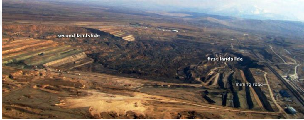
Şekil 4.4: Afşin-Elbistan Termik Santrali Linyit Sahasında Meydana Gelen Maden Kazası (Şev Kayması-Heyelan). [17].
