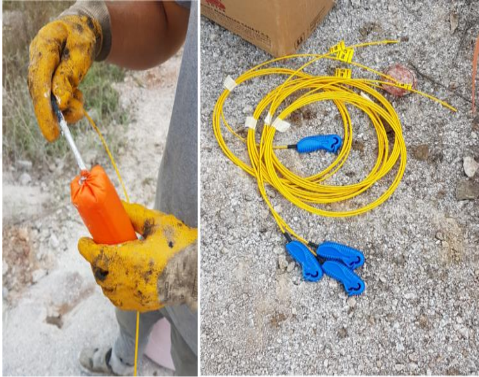
Şekil 5.20: Emulite Kapsüle Duyarlı Patlayıcı, Dip Kapsül (Solda) ve 67 Ms Ayarlı Elektriksiz Kapsül (Sağda).
