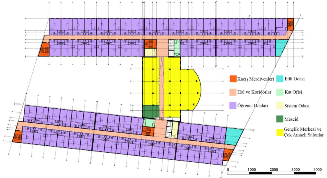
Şekil 28 Örneklem binası 2. kat planı
