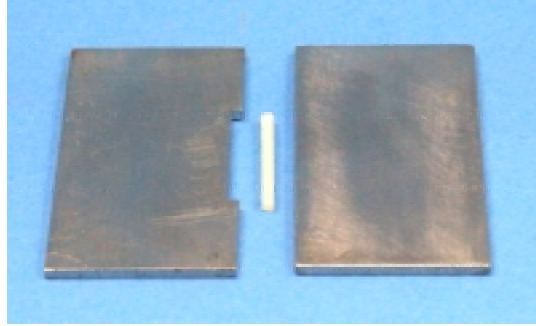
Resim 2.9. Kırılma dayanımı örneği ve kalıbı
