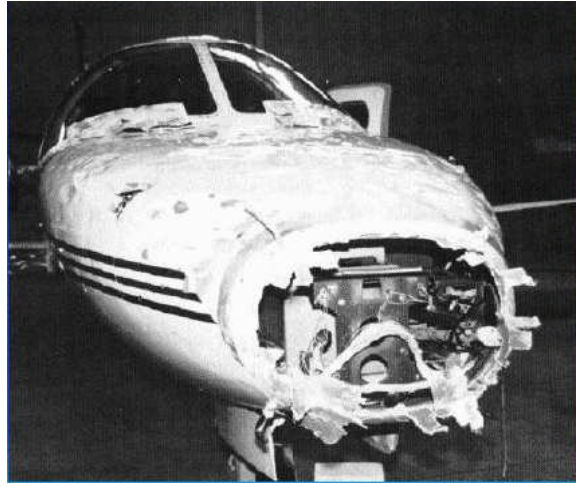
Şekil 1.22. Hava Aracı Üzerinde Dolu Etkisi(Meteoroloji Ders Kitabı,2002)
