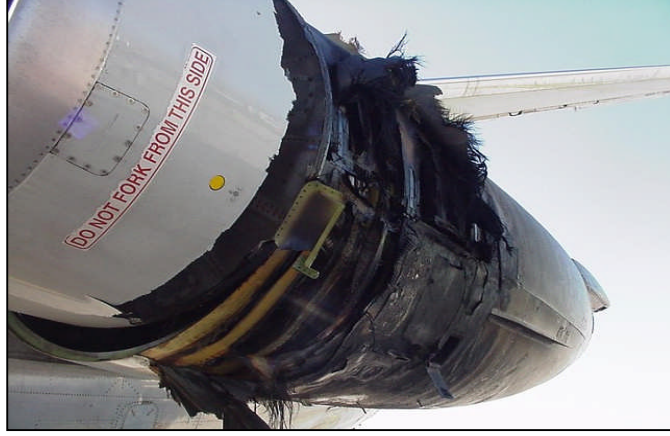
Şekil 1.30. Sol Motor Yangın Hasarı (NTSB,2006)
