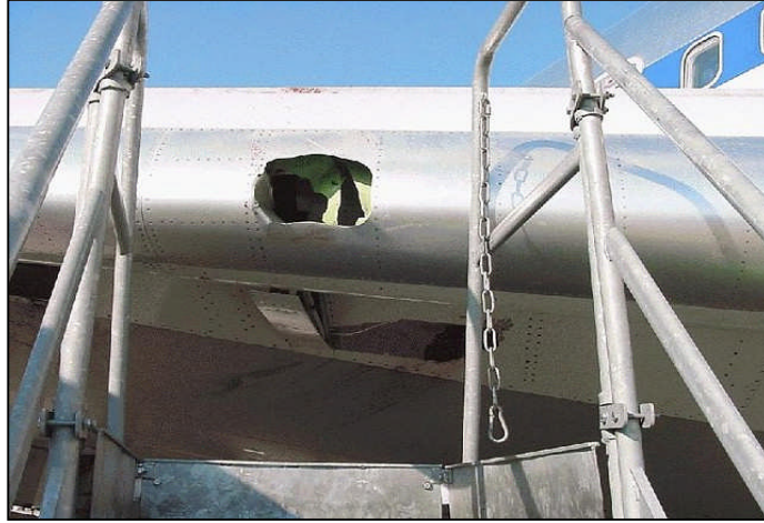
Şekil 1.33. Kanat Bölümündeki Çöküntü (NTSB,2006)
