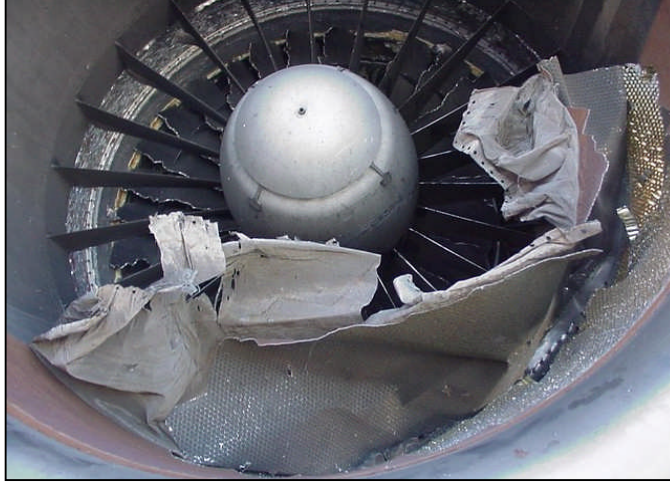
Şekil 1.32. Hasara Uğramış Motor Kanatçıkları (NTSB,2006)
