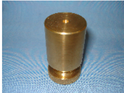
Şekil.2.22. Tabakalama işlemi için hazırlanan pirinç tutucu
