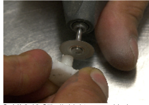
Şekil 2.12. Silindir bloktan örneklerin hazırlanması
