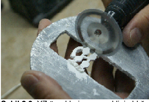
Şekil 2.9. YZ örneklerin son şeklini aldığı Zirkozahn sisteminden çıkarılışı
