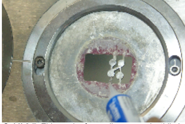
Şekil.2.7. Zirkonzahn freze cihazına yerleştirilmiş metal koping
