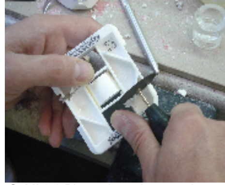
Şekil 2.2. Bloğun kenarlarının micracut cihazı için hazırlanması
