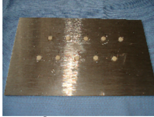
Şekil.2.25.Örneklerin metal plakaya yerleştirilmesi
