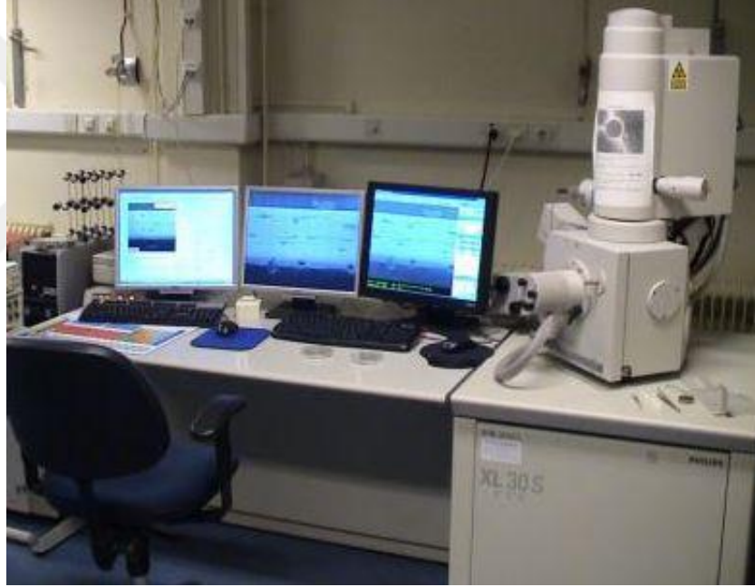
Şekil 4.5. Philips XL 30 S FEG taramalı elektron mikroskobu (SEM-EDS)
