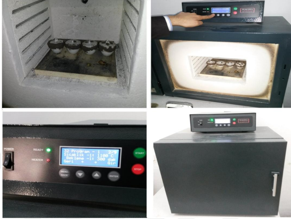
Şekil 4.4. Magma Therm kül fırını ve numunelerin yerleştirilmesi
