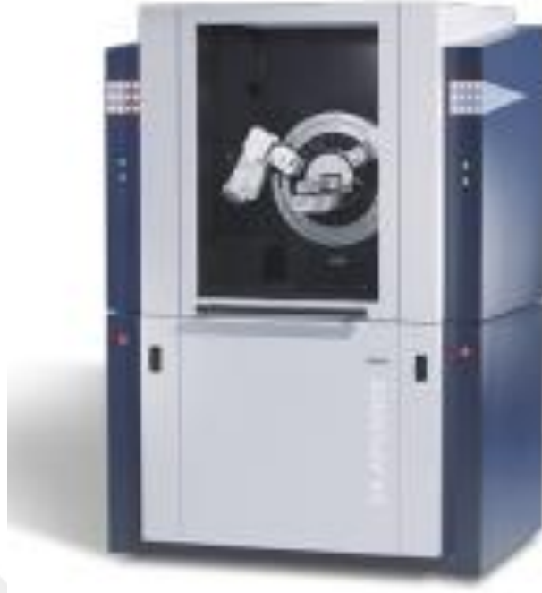
Şekil 4.6. Bruker D8 X-ışını kırınım cihazının genel görünümü (XRD)
