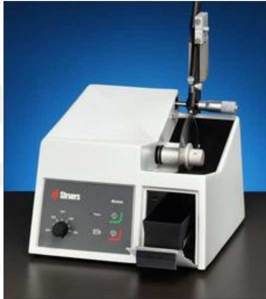
Şekil 4.2. Struers Minitom hassas kesme cihazı
