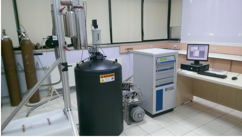
Şekil 4.8. Titreşimli örnek magnetometresi (VSM) entegreli Quantum Design PPMS sistemi
