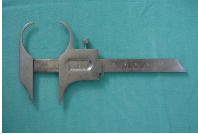
Şekil 5. Maksimum ağız açıklığı miktarını ölçmek için kullanılan milimetrik kumpasın görünümü.
