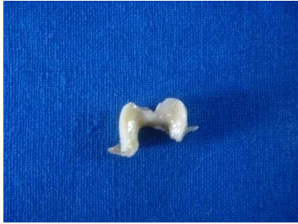
Şekil 2.11. Fırından çıkmış fazla cam kristalleri uzaklaştırılmamış porselen örnek.
