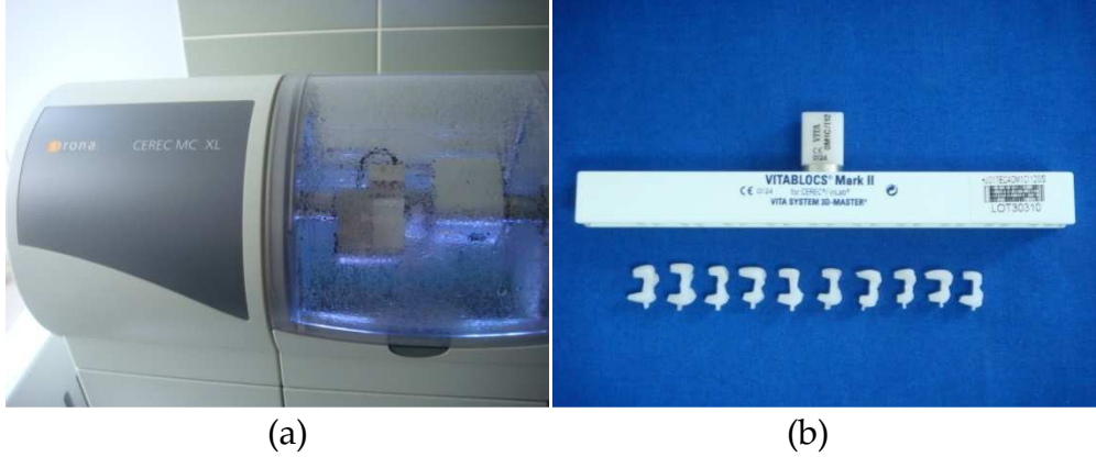
Şekil 2.19. (a) Blokların freze ünitesine yerleştirilmesi (b) Freze sonrası elde edilen örnekler.
