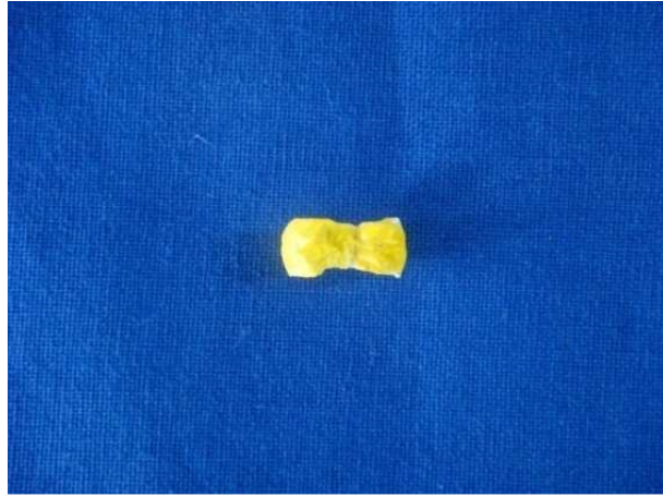
Şekil 2.10. Camın likitini emmemesi için uygulanan separatör.
