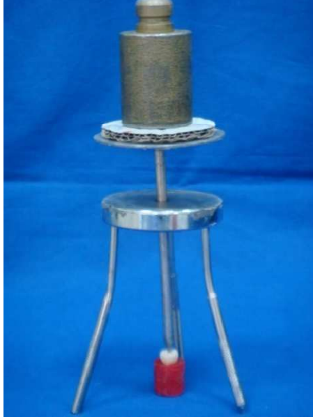
Şekil 2.20. Simantasyon sırasında 1 kg statik yük uygulanması.
