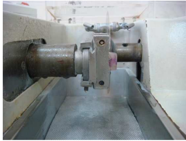
Şekil 2.29. Örneklerden kesit alınması.
