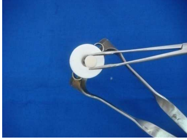
Şekil 2.7. Sıcak döküm silindirine soğuk ingotlar ve alüminyum oksit pistonun yerleştirilmesi.
