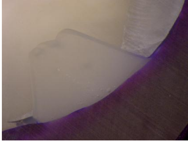
Şekil 3.8. Dualink ile yapıştırılmış kompozit inley örnek (x40) kesiti
