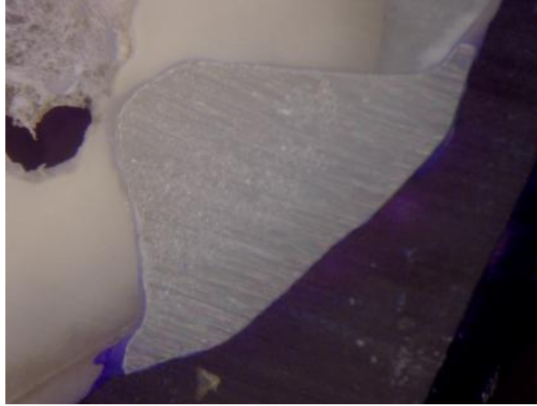
Şekil 3.13. Bisem ve z-primer ile yapılandırılmış CERECON zirkonyum inley örnek (x40) kesiti
