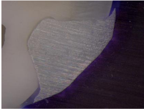
Şekil 3.14. Dualink ve z-primer ile yapılandırılmış CERECON zirkonyum inley örnek (x40) kesiti
