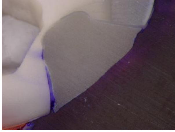
Şekil 3.7. Bisacem ile yapıştırılmış CEREC3 inley örnek(x40) kesiti
