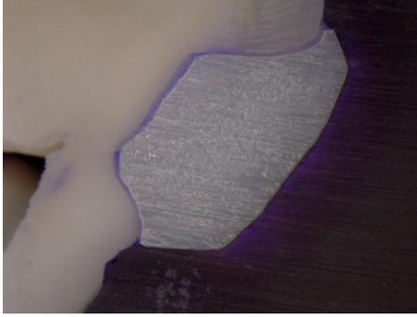
Şekil 3.4. Bisem ile yapıştırılmış CERECON zirkonyum inley örnek (x40) kesiti
