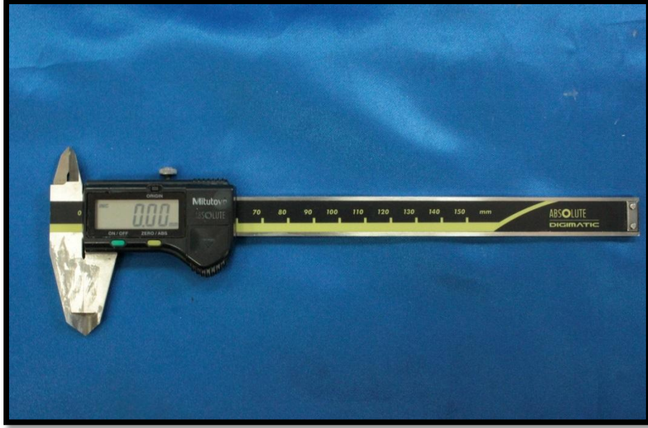
Şekil 2. 1. Çalışmada kullanılan ve 0,01 mm hassasiyet gösteren kumpas
