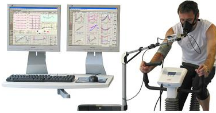
Şekil 2. 3. Maksimal ve submaksimal testlerde kullanılan ergospiromtre sistemi
