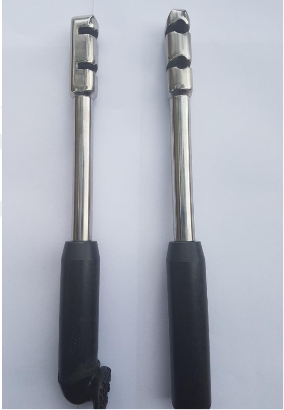
Şekil 2.3. SOP plađın özel bükme demirleri.
