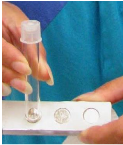
Şekil 1.1. Lektinler ile kaplanmış nanopartiküllerin bağlandıkları spermatozoa ile birlikte sperma örneğinden mıknatıs yardımı ile uzaklaştırılması (Odhiambo ve ark., 2014).
