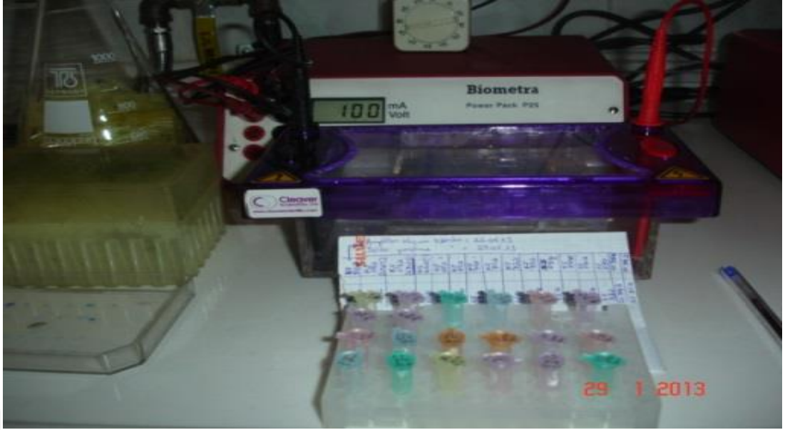
Şekil 2.10. Güç kaynağı ile elektroforez işlemi.
