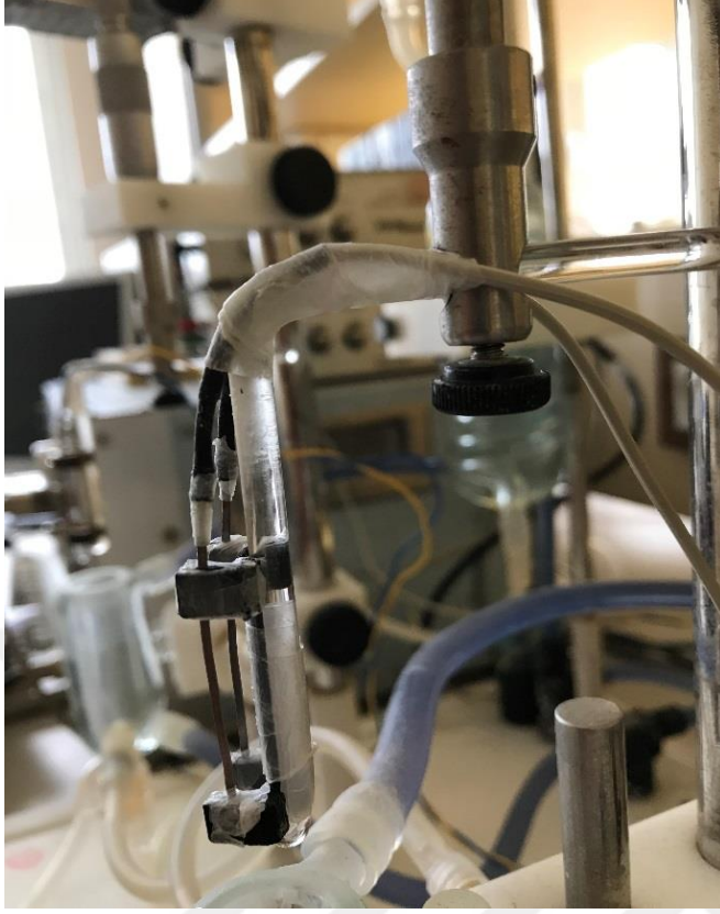
Şekil 2.7. Elektriksel alan elektrodu
