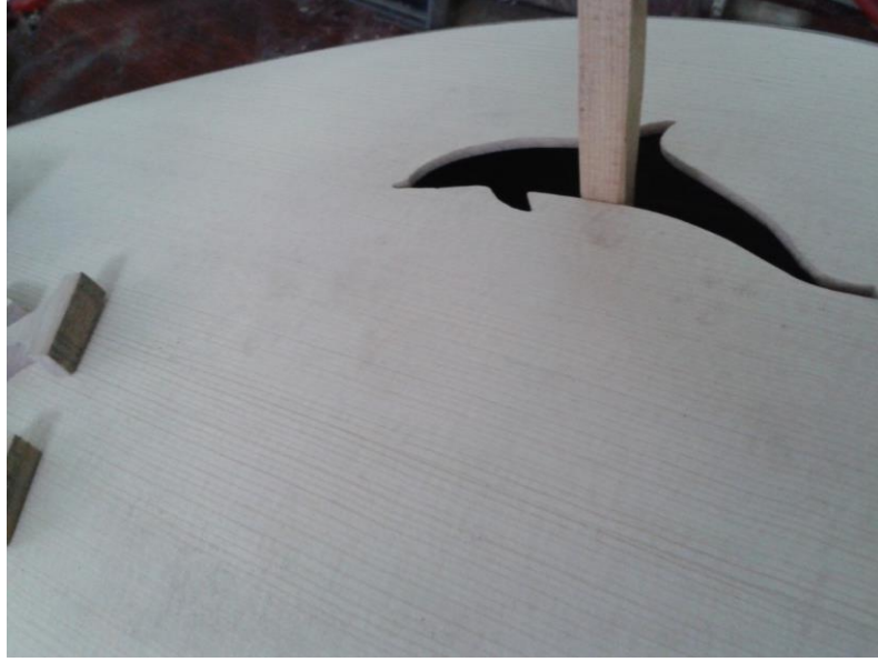
Şekil 4.73 : Can direk boyunun tespiti
