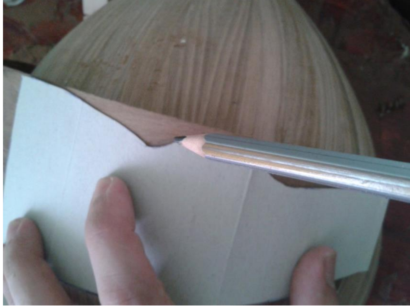
Şekil 4.21 : Mukavemet dilimine şekil verilmesi
