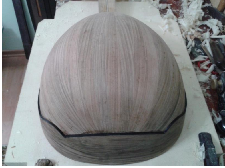
Şekil 4.42 : Kapak formunun çizilmesi
