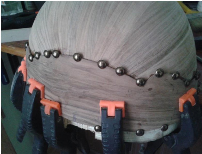
Şekil 4.24 : Mukavemet diliminin tekne üzerine yapıştırılması
