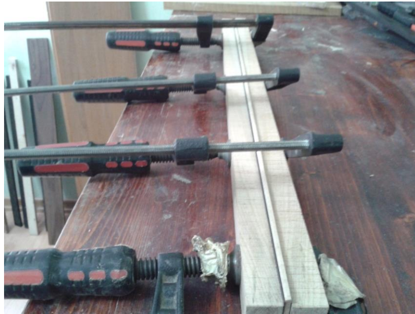
Şekil 4.29 : Sap ağacı parçalarının yapıştırılması işlemi
