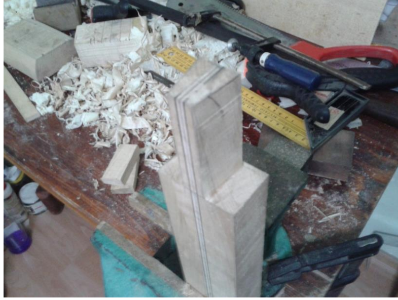
Şekil 4.31 : Sap birleşim bölgesinin kesim işleminden sonraki görünümü
