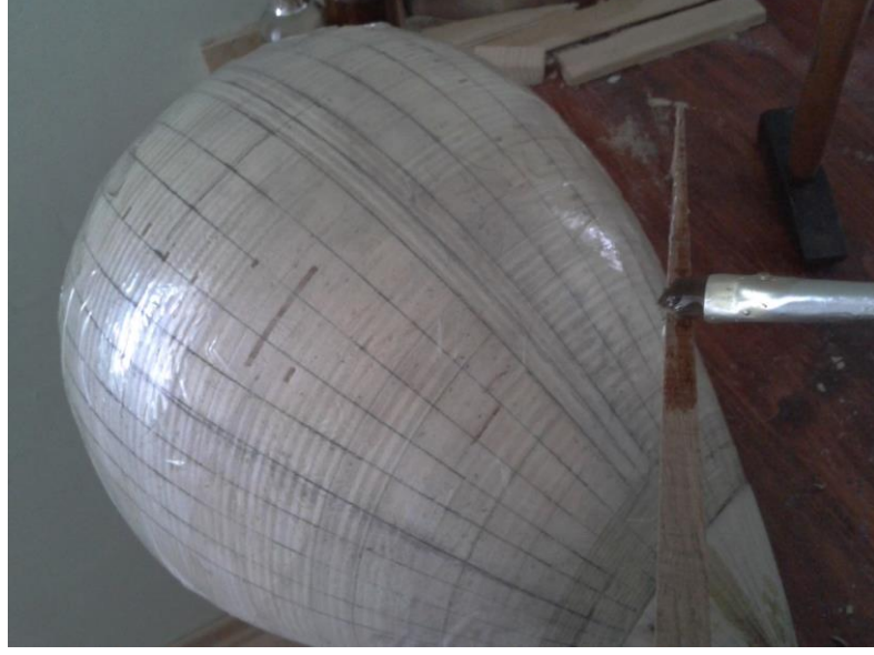
Şekil 4.14 : Yapıştırılmaya hazır olan dilime gluten tutkal sürülmesi
