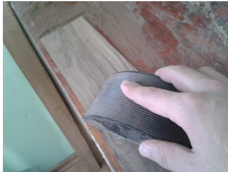
Şekil 4.19 : Tekne dışı mukavemet diliminin yapımı
