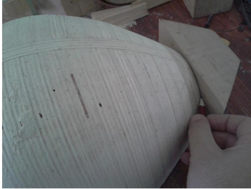
Şekil 4.1 : Takozluk ağacın yerleştirilip kalıp formuna uygun olarak işaretlenmesi
