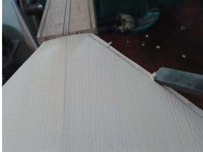
Şekil 4.61 : Fileto kanalı açılması
