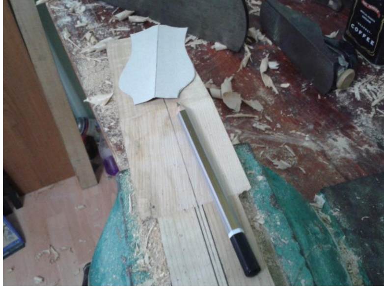
Şekil 4.39 : Burguluk formunun çizilmesi
