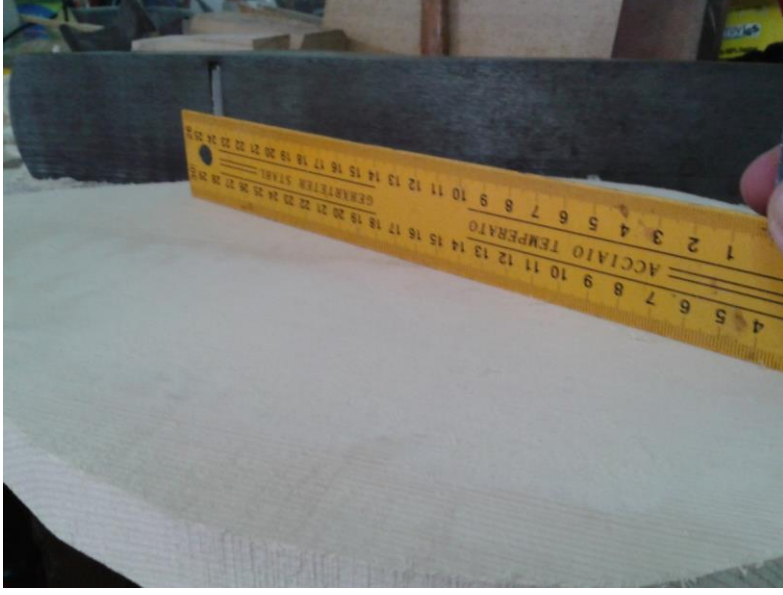
Şekil 4.44 : Kapak tabanının tesviyesi
