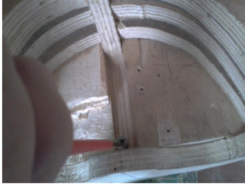
Şekil 4.4 : Takozun uzun bir ağaç vidası yardımıyla kalıba sabitlenmesi
