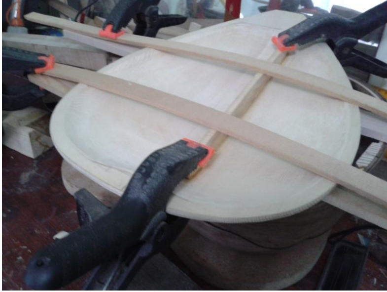
Şekil 4.51 : Bas balkonun yapıştırılması
