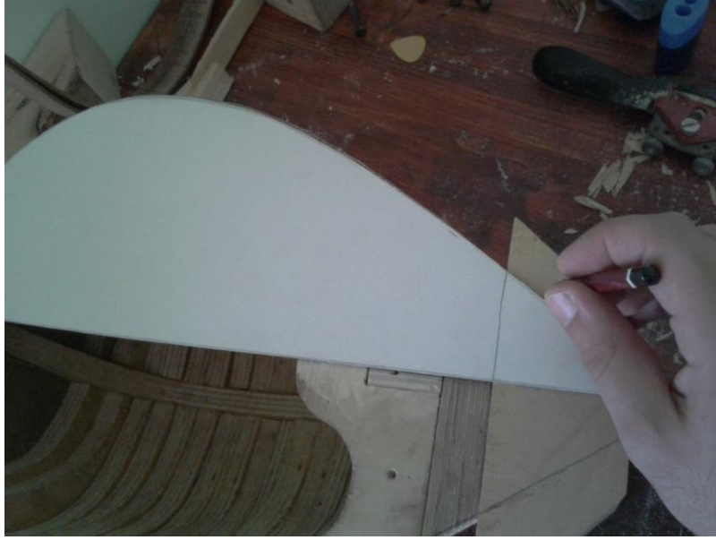
Şekil 4.2 : Takozun şablon yardımıyla tekne formuna uygun olarak işaretlenmesi
