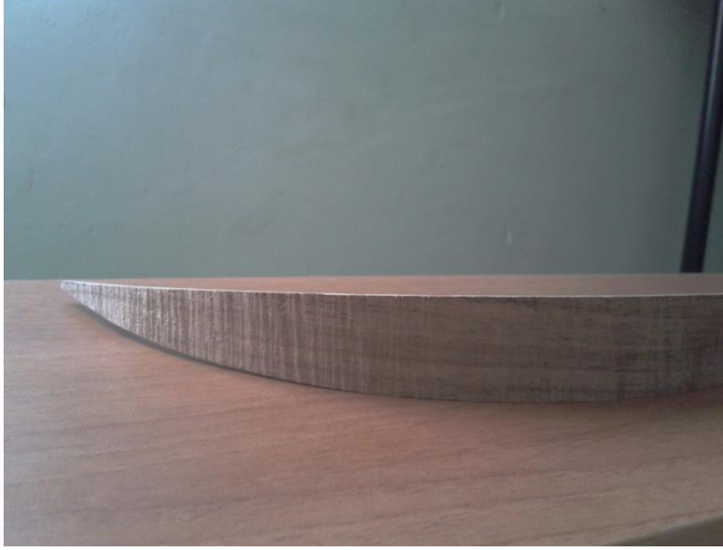
Şekil 4.13 : Dilim yan yüzeylerinin düzgünlüğünü kontrol işlemi
