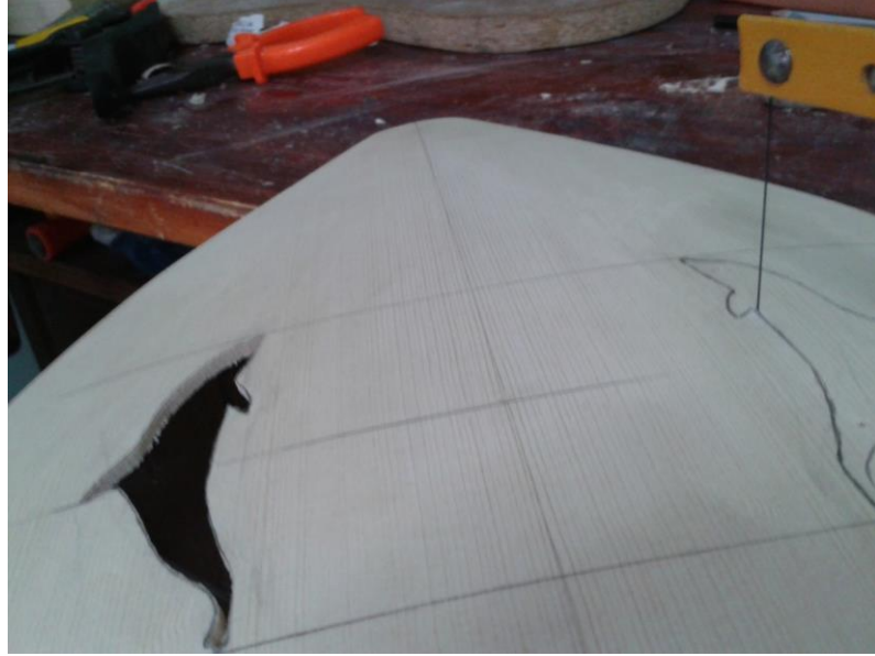
Şekil 4.53 : Ses deliklerinin kesilmesi
