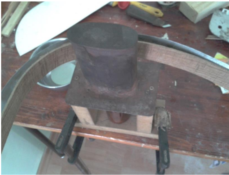
Şekil 4.10 : Dilim bükme işlemi sonu
