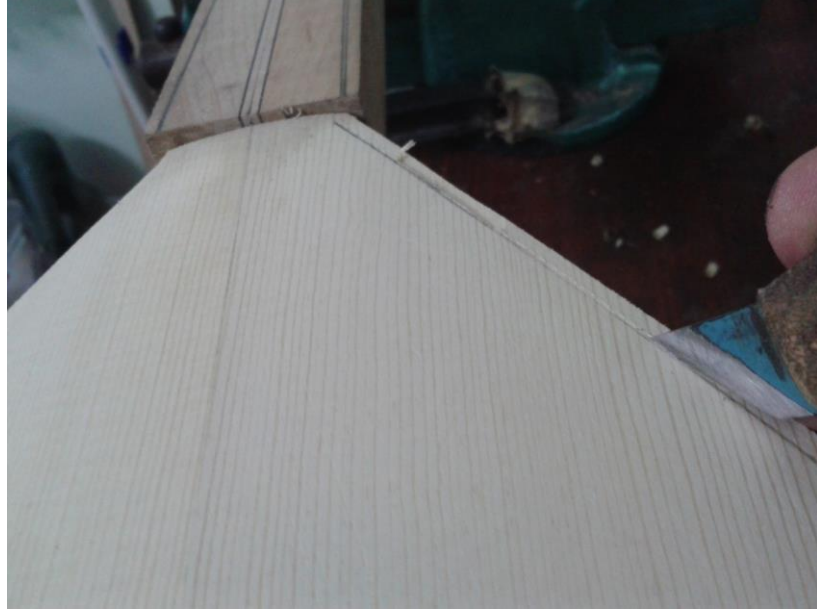
Şekil 4.60 : Fileto kanalı çizilmesi
