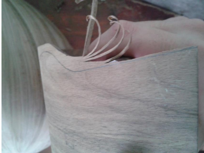
Şekil 4.22 : Mukavemet diliminin bıçak yardımı ile işlenmesi
