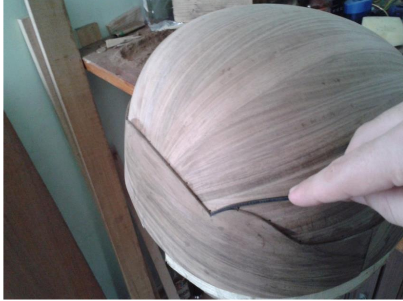
Şekil 4.25 : Mukavemet dilimi kenar filetolarının yapıştırılması
