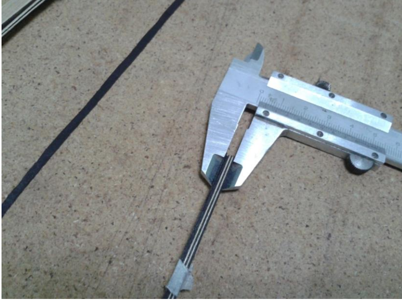
Şekil 4.58 : Kapak kenar filetosunun oluşturulması
