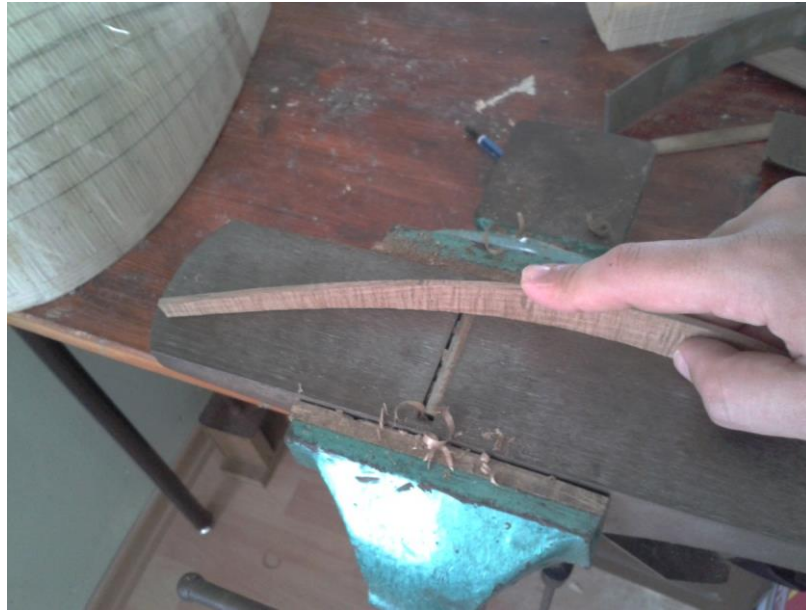
Şekil 4.12 : Dilimlik ağacın şekillendirilmesi
