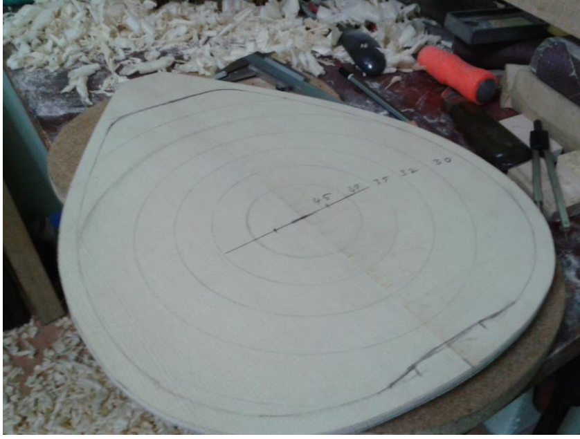
Şekil 4.47 : Ölçülendirme hatlarının çizimi
