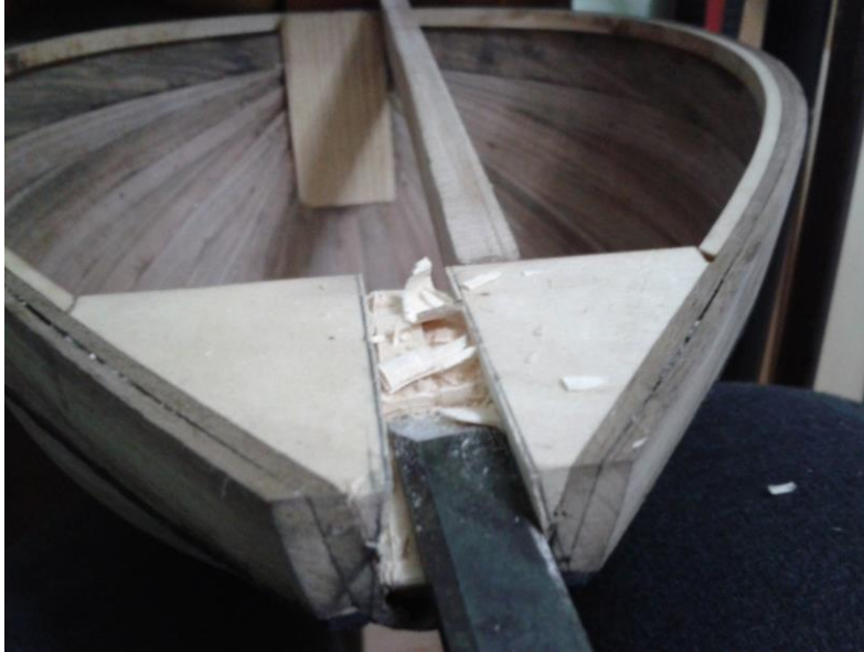
Şekil 4.34 : Kesilen kısımlar arasında kalan ağacın tıraşlanması
