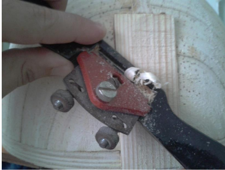
Şekil 4.7 : Arka takozun pastran kolu yardımı ile şekillendirilmesi
