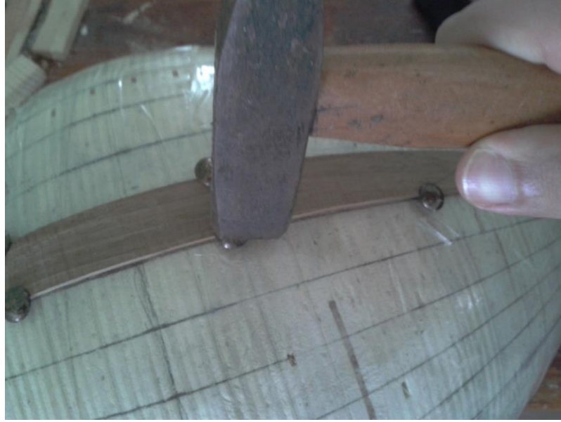
Şekil 4.15 : İlk tekne diliminin yapıştırılması
