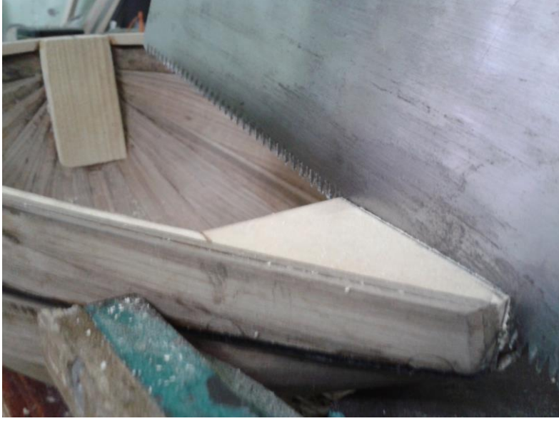
Şekil 4.33 : Takoza üzerindeki sap birleşim yerinin kesilmesi
