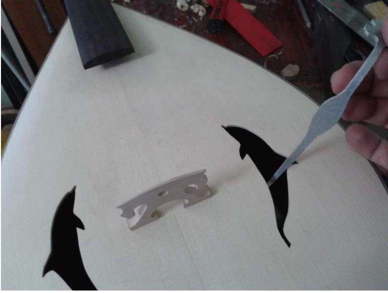
Şekil 4.75 : Can direk takma işlemi
