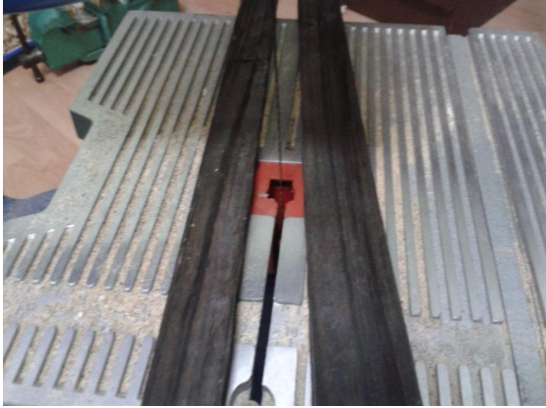
Şekil 4.62 : Klavye ağacının kesilmesi
