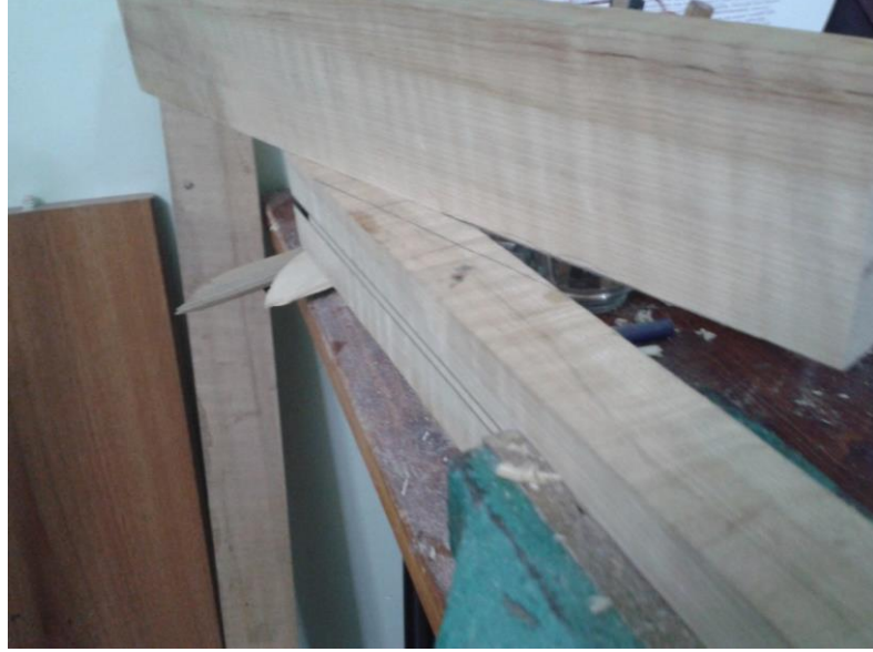
Şekil 4.36 : Burguluk kısmının hazırlanması
