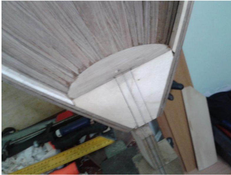
Şekil 4.32 : Hazırlanan sap ağacı kılavuzluğunda tekne takozunun çizilmesi
