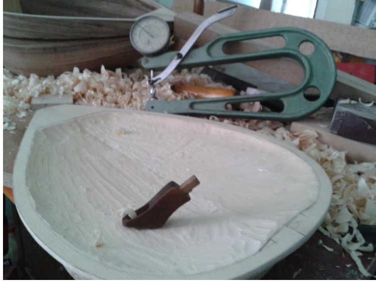
Şekil 4.49 : Parmak rendesi ile hassas ölçülendirme
