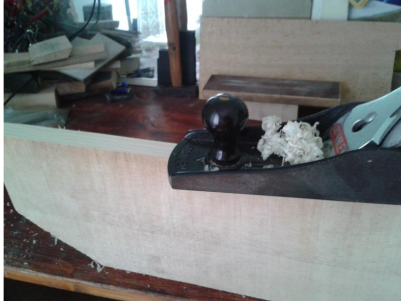
Şekil 4.40 : Kapak yapışma yüzeyinin planya ile tesviye edilmesi
