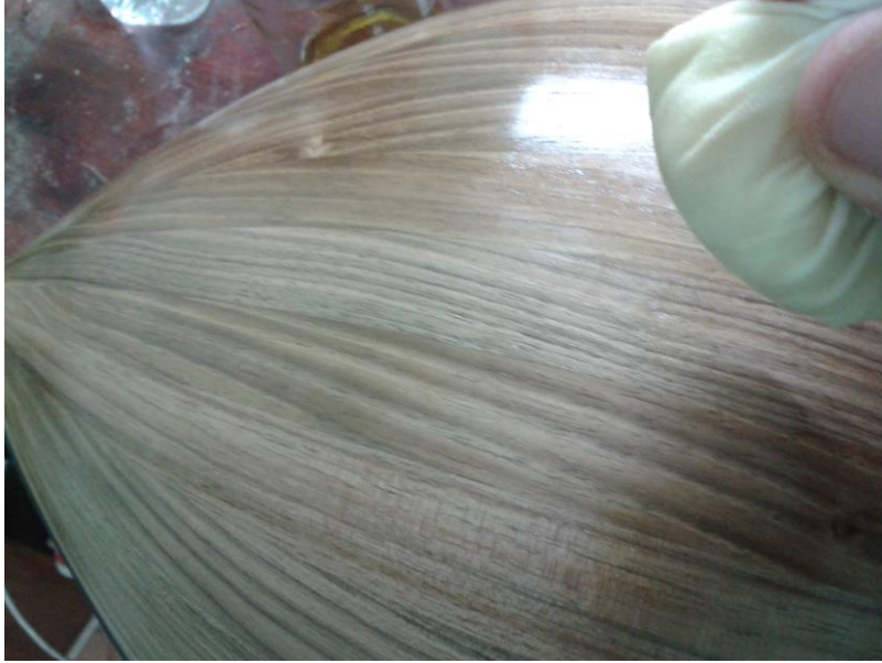
Şekil 4.72 : Gomlak cilası işlemi
