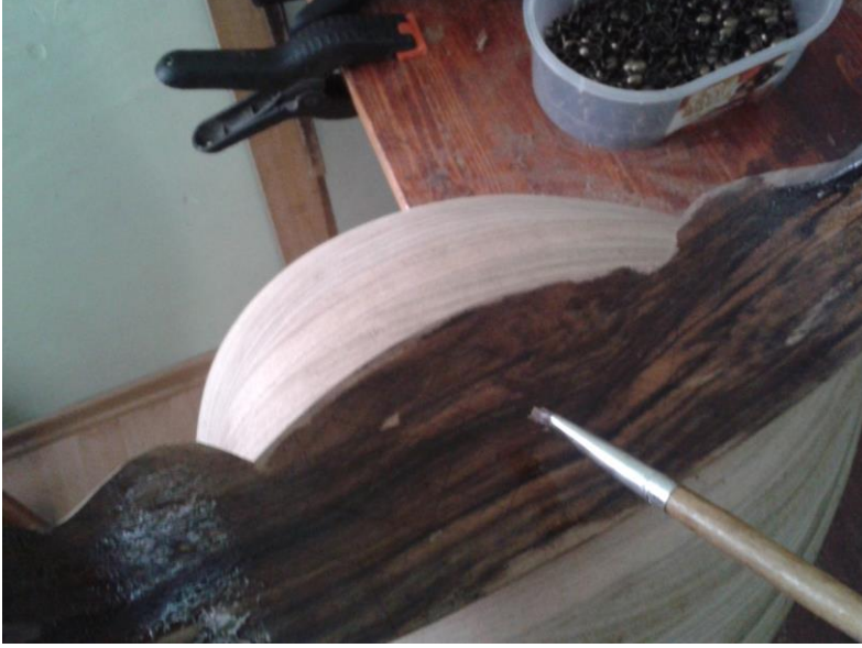
Şekil 4.23 : Mukavemet dilimine tutkal sürülmesi
