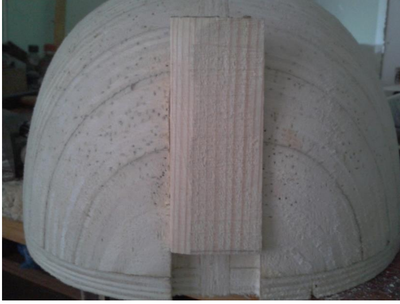
Şekil 4.6 : Arka takozun geçmeli olarak kalıba yerleştirilme işlemi
