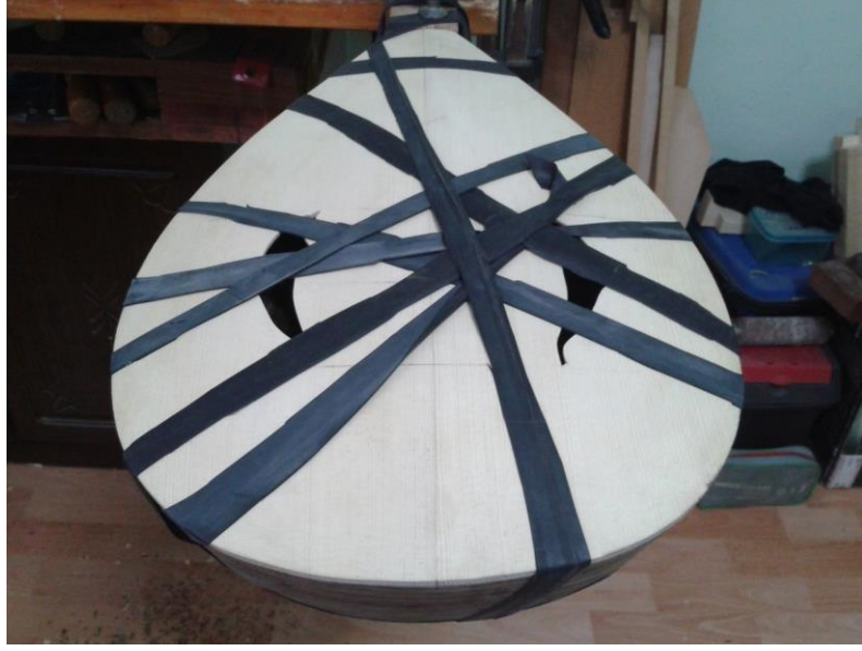
Şekil 4.56 : Kapağın tekneye yapıştırılması
