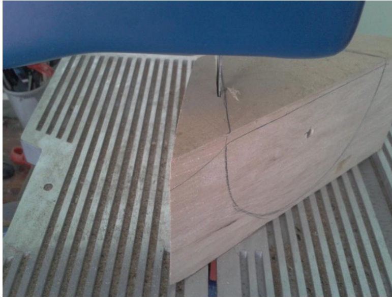
Şekil 4.3 : İşaretlenen takozun şerit testere yardımı ile kesilmesi
