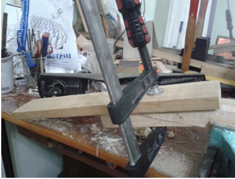
Şekil 4.38 : Burguluk yapıştırma işlemi
