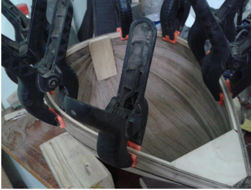
Őekil 4.27 : Tekne ii mukavemet ıtalarının yapıŐtırılması
