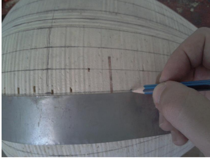
Şekil 4.8 : Dilim taksimatı ve işaretlenmesi işlemi
