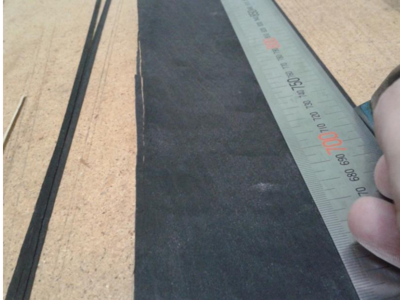
Şekil 4.57 : Fileto ağacının kesilmesi
