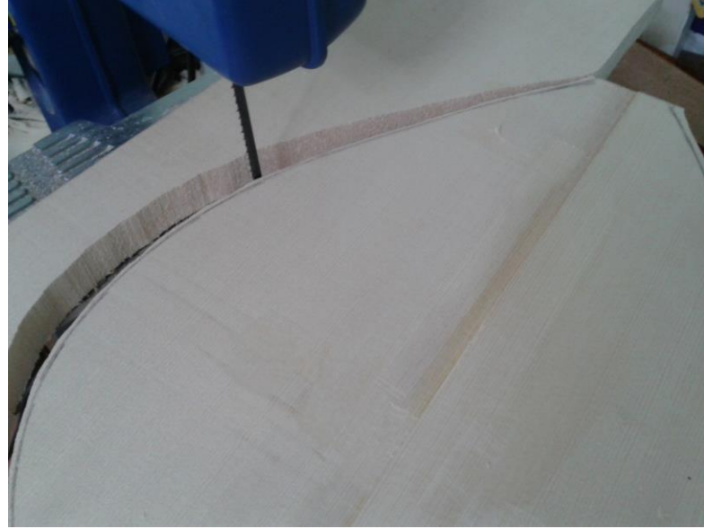
Şekil 4.43 : Kapak formunun şerit testere yardımı ile kesilmesi
