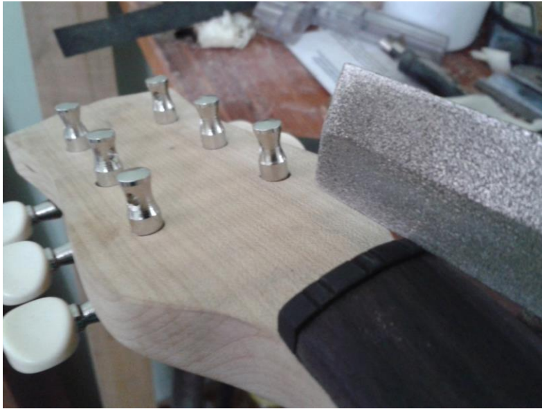
Şekil 4.76 : Baş eşik tel çentiklerinin açılması
