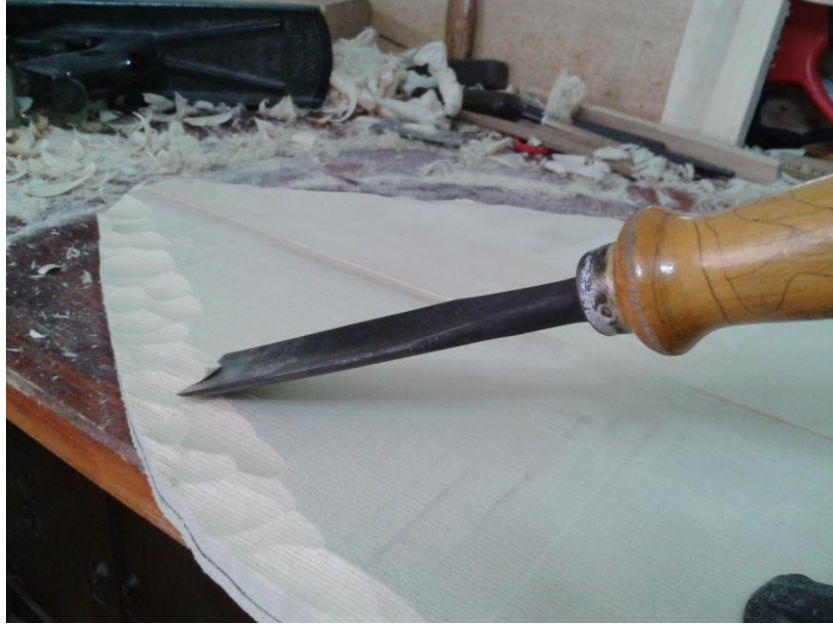
Şekil 4.46 : İskarpela ile kapak kenarlarının tıraşlanması
