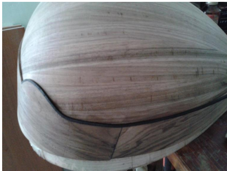
Şekil 4.26 : Mukavemet filetolarının yapıştırılma sonrası görünümü
