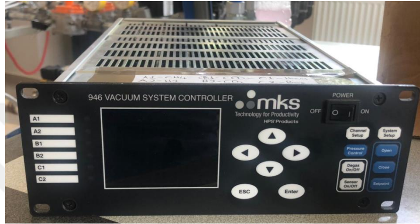
Şekil 2.11. Vakum sistem kontrolcüsü
