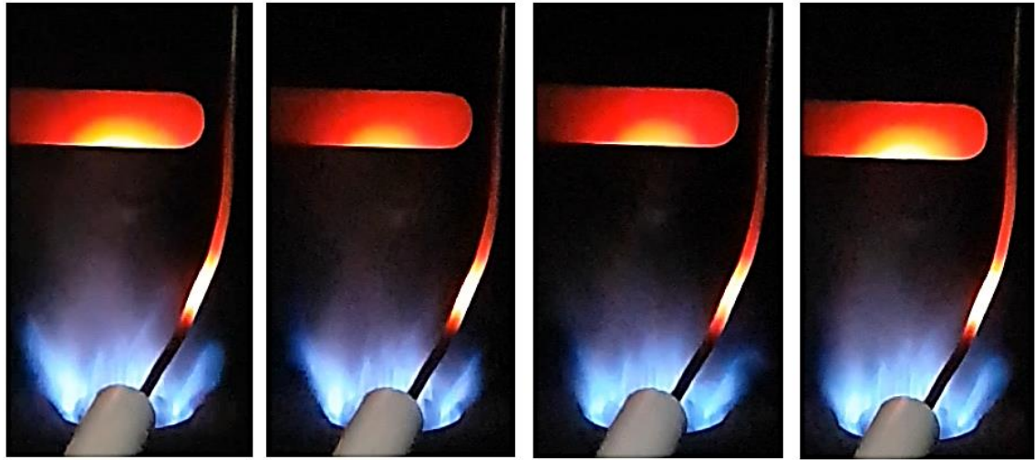
Zorlamasız 95 Hz 175 Hz 260 Hz Şekil 3.43. H_2/CO = 1,5 için %23 O_2 içerikli hava ile yanması alev görüntüleri
