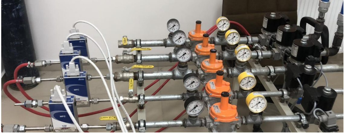
Şekil 2.9. Gaz akış hatları
