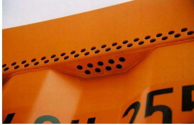
Şekil.9. Havalandırılmalı Konteynerin Havalandırma Bölmesi 35
