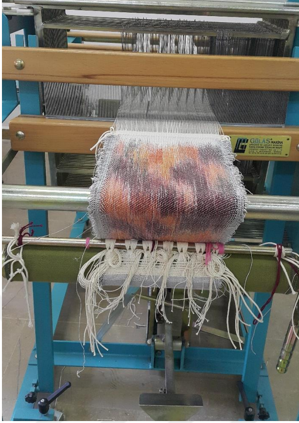
Resim 81 Çözgü İkat Dokuma Tezgahında Bitmiş Hali
