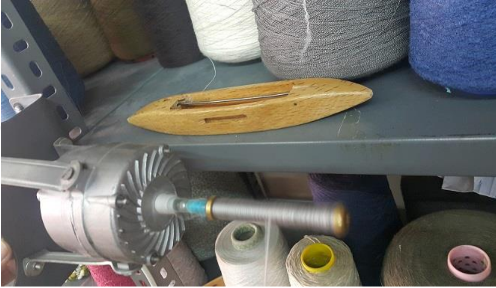
Resim 78: Mekik Ve Atkı Masurasına İplik Sarma İşlemi
