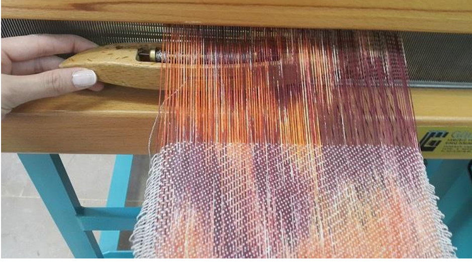
Resim 79: Çözgü İplikleri Üzerine Atkı Atma İşlemi
