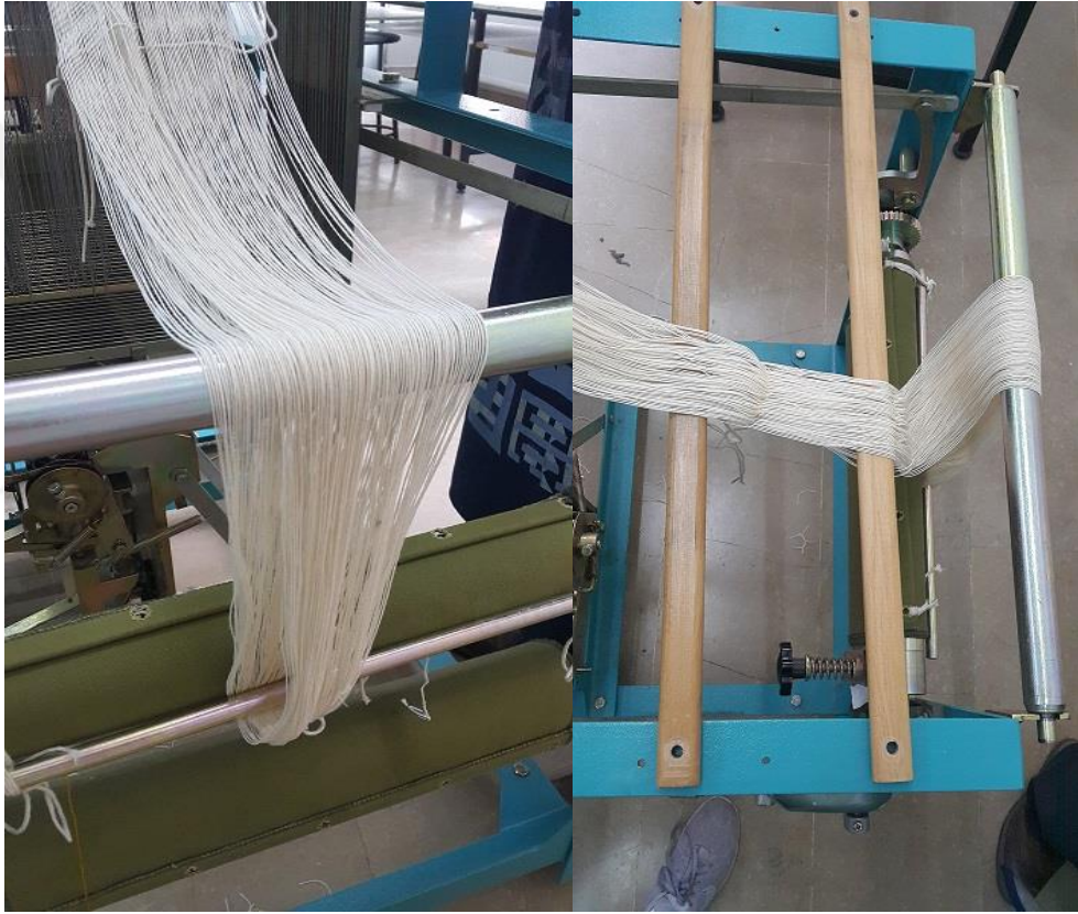
Resim 72: Çözü İpliklerinin Tezgaha Aktarılması
