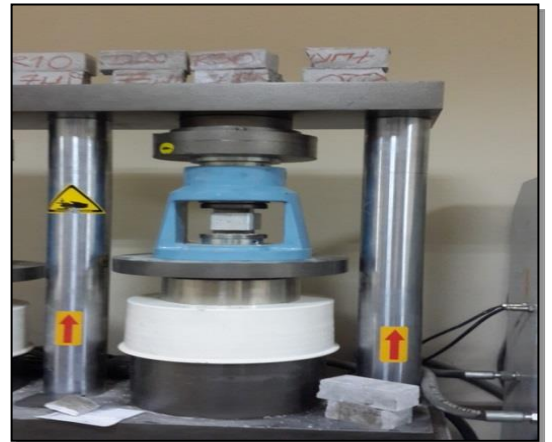
Şekil B.6 Çimento pres makinasının eğilme ve basınç aparatı
