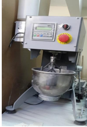
Şekil 3-14 Karıştırma makinesi (TS EN 196-1 'e uygun)
