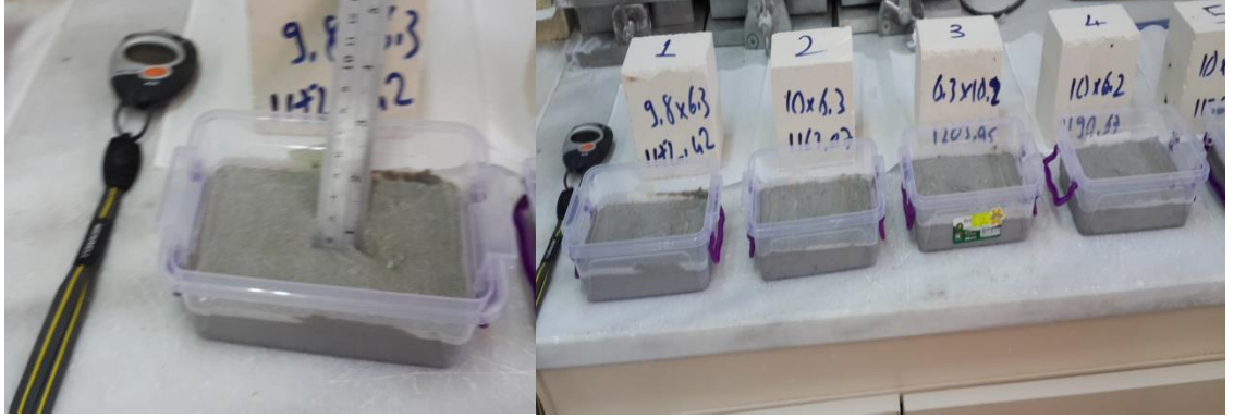
Şekil 3-18 Harç kalınlığı ölçümü ve deney kaplarının hazırlanışı
