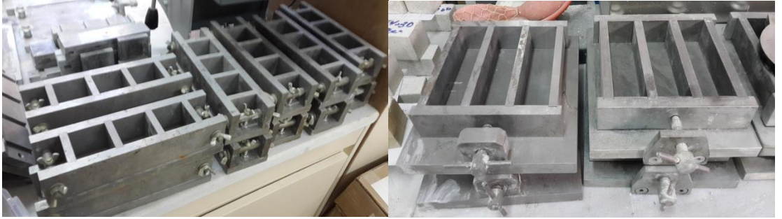
Şekil 3-11 40x40x40 küp kalıplar ve 40x40x160 kiriş çelik kalıplar
