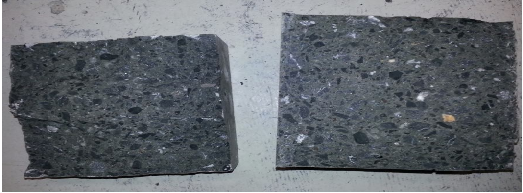
Şekil 3.26 BA-D5 Bazalt Karışım deney sonucuna ait basınçlı su emme deneyi numunesi
