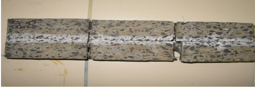
Şekil 3.21 BA-D1 Bazalt agregaları kullanılarak yapılan KYB’de klorür geçirimliliği
