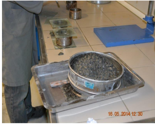
Şekil B.8 Taze Beton Priz Süresi Deneyinde Betonun 5 mm Elekten Elenmesi
