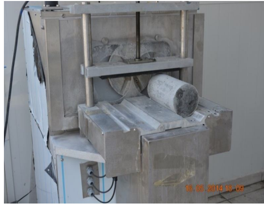
Şekil 3.14 100/200 mm silindir numunelerin alt ve üst yüzeylerinin aşındırma makinası
