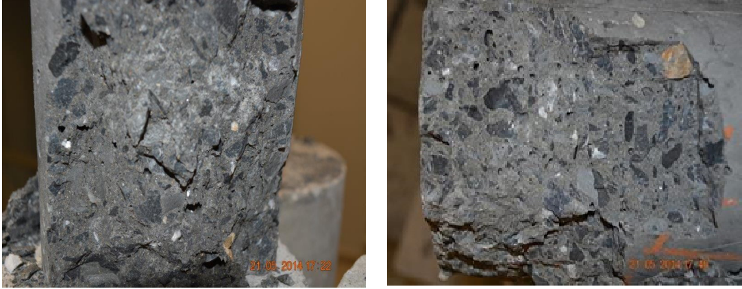
Şekil B.10 BA-D1 Numunesinin Basınç Dayanım Deney Sonrası Görünümü
