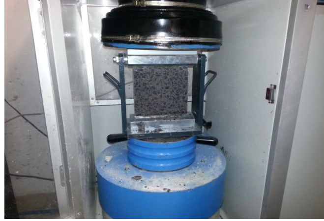
Şekil 3.24 Numunenin basınçlı su uygulanan yüzeye dik şekilde ortasından yarılması
