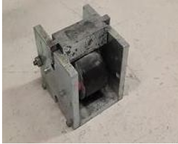
Şekil B.5 Klorür Geçirimsizliği Deneyinde Kullanılan Yarma Aparatı
