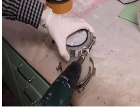
Şekil B.7 Klorür Geçirirnililiđi Deneyinde Numunenin Kelepçe İle Sıkılması
