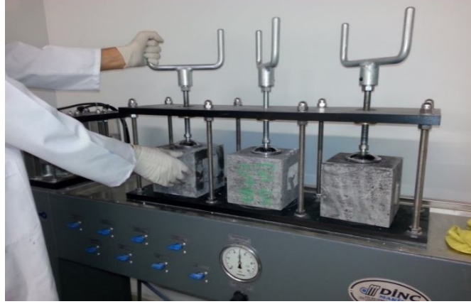
Şekil 3.23 Basınçlı su emme deneyi için numunenin deney düzeneğine yerleştirilmesi
