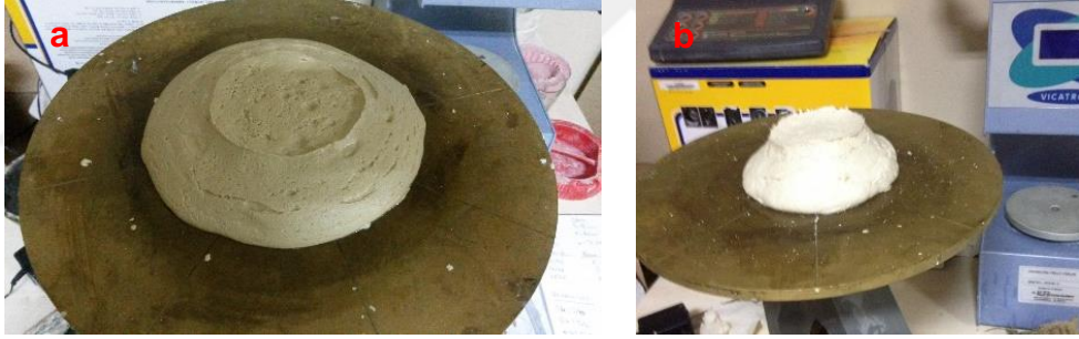
Şekil 4.6 : a) Lifsiz numunelerde yayılma deneyinin son durumu b) Lifli numunelerde yayılma deneyinin son durumu
