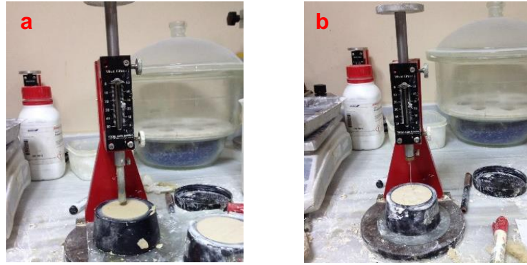
Şekil 4.3 : a) Vicat cihazında kıvam belirlenmesi b) Priz başlangıcı ve priz sonu belirlenmesi
