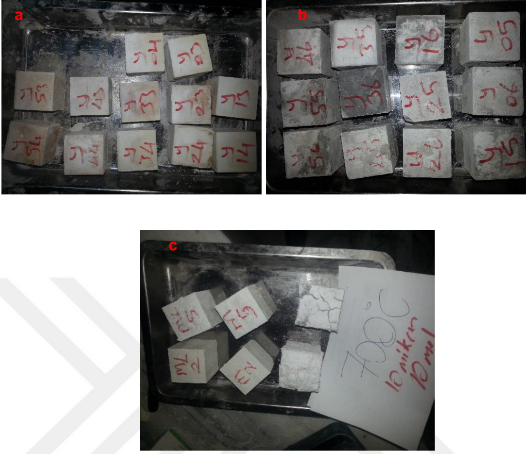
Şekil 4.34 : a)300 °C etüv sonrası b)500 °C etüv sonrası c)700 °C etüv sonrası numune görüntüleri
