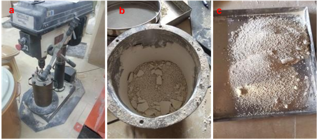
Şekil A.2 : a) Blender tipi öğütücü b) Paletlerin sıyıramadığı kenarlara yapışan BT c) Öğütme sonunda çıkarılan numune ve bilyeler
