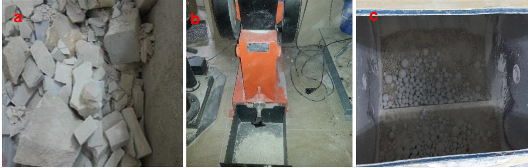
Şekil A.1 a) BT'nin laboratuvar ortamına getirilmesi b) BT'nin konkasörde 0-2 mm boyutlarına indirgenmesi c) BT'nin Los Angeles cihazına yerleştirilmesi
