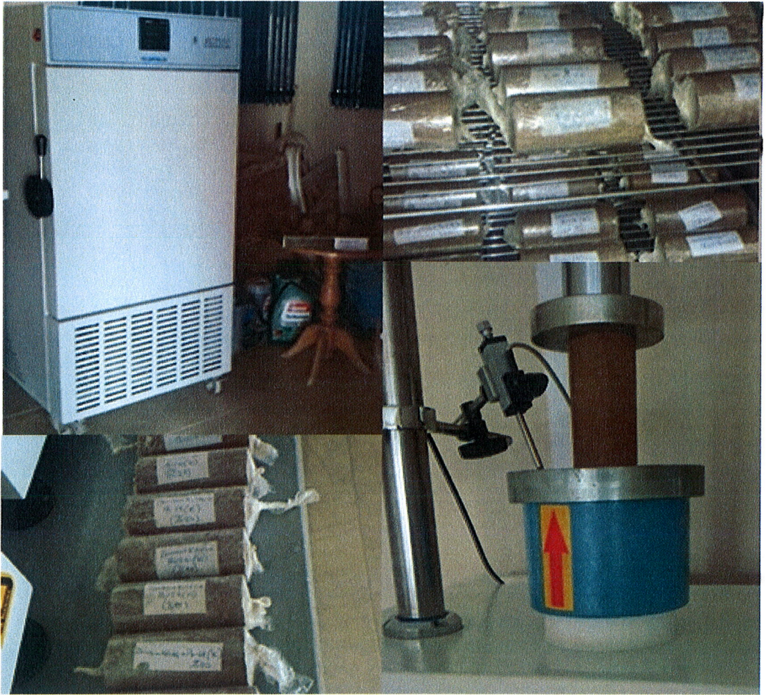
Şekil 4.44 Donma-çözülme çevrimi ve tek eksenli basınç dayanımı işlemleri
