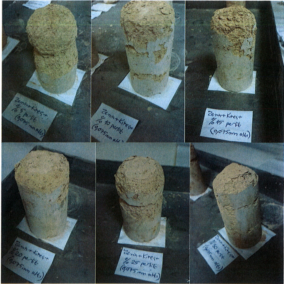
Şekil 4.43 12 kez ıslanma-kuruma sonrasındaki SLP2 karışım numunelerinin görüntüleri
