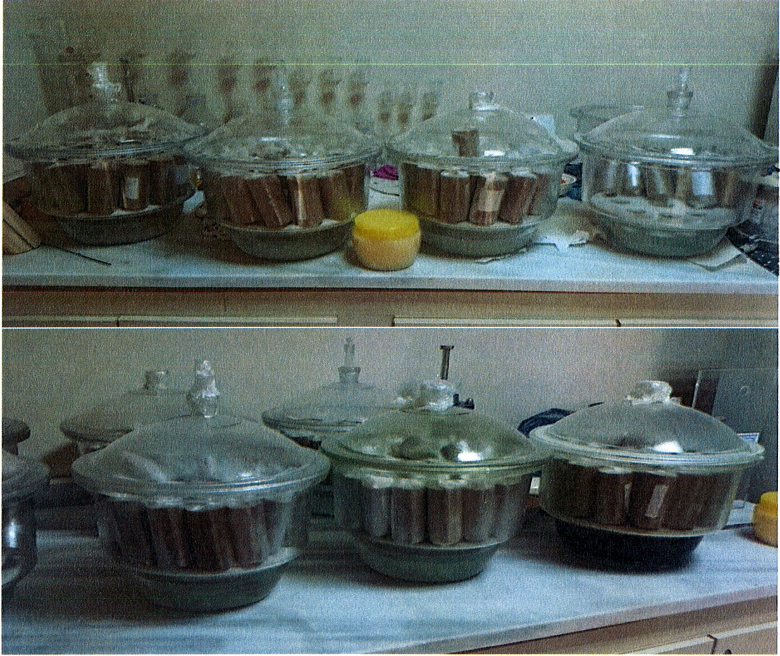
Şekil 4.12 Deney numunelerine desikatör içerisinde kür uygulanması
