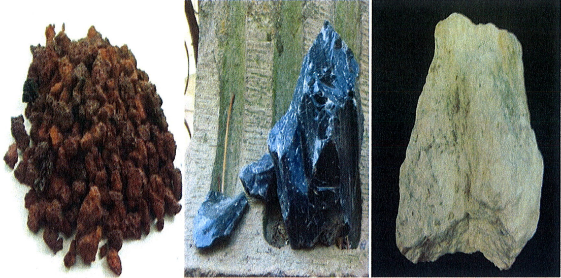
Şekil 2.4 Doğal puzolanların bazıları (volkanik tüf, volkanik cam, diatomit)
