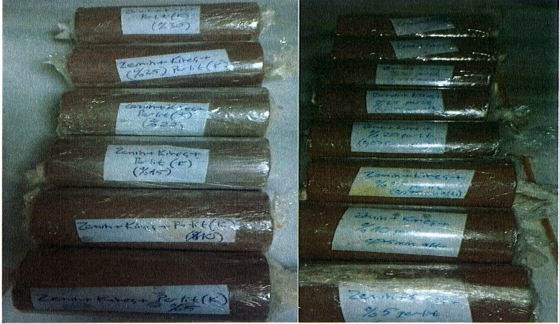
Şekil 4.24 Islanma-kuruma periyodu için hazırlanan deney numuneleri
