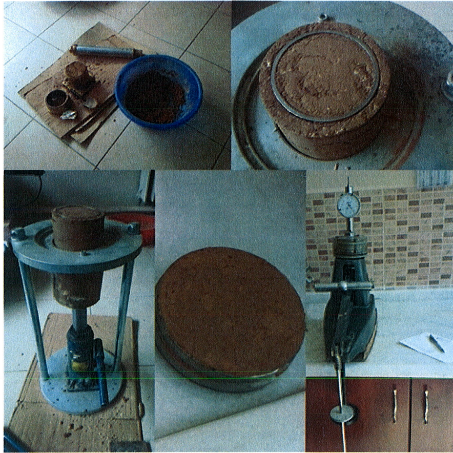
Şekil 3.15 Şişme yüzdesi deney düzeneği
