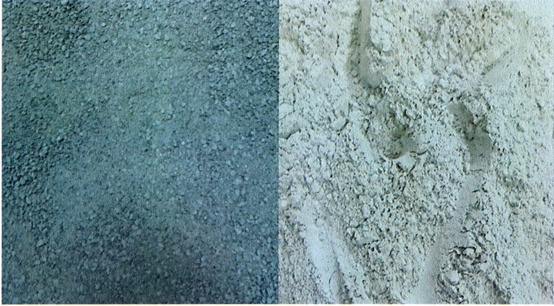
Şekil 3.7 Doğal perlit ve elek açıklığı 0,075 mm altı perlit
