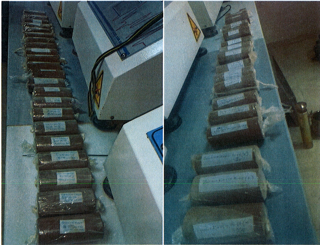
Şekil 4.11 Serbest basınç deneyi numunelerinin bazılarının görüntüleri
