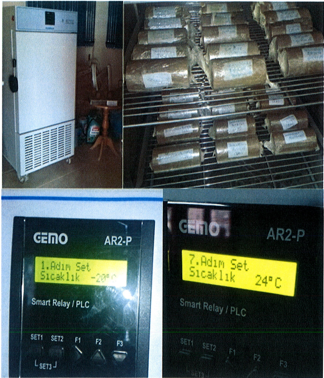
Şekil 3.14 Donma-çözülme deney düzeneği
