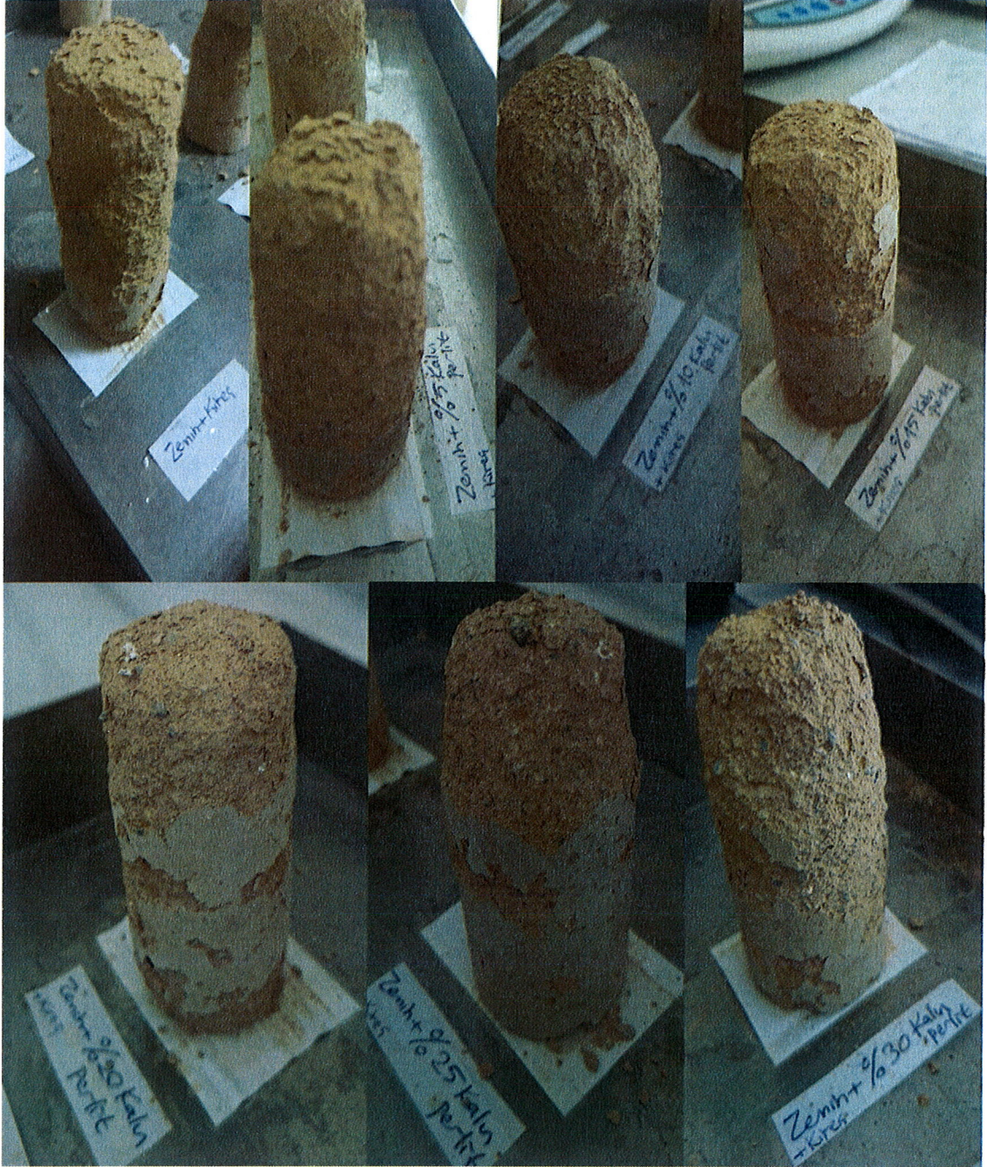
Şekil 4.35 12 kez ıslanma-kurumaya maruz kalmış SL ve SLP1 karışım numunelerinin görüntüleri
