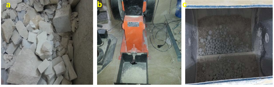
Şekil 3.8 a) BT'nin laboratuvar ortamına getirilmesi b) BT'nin konkasörde 0-2 mm boyutlarına indirgenmesi c) BT'nin Los Angeles cihazına yerleştirilmesi
