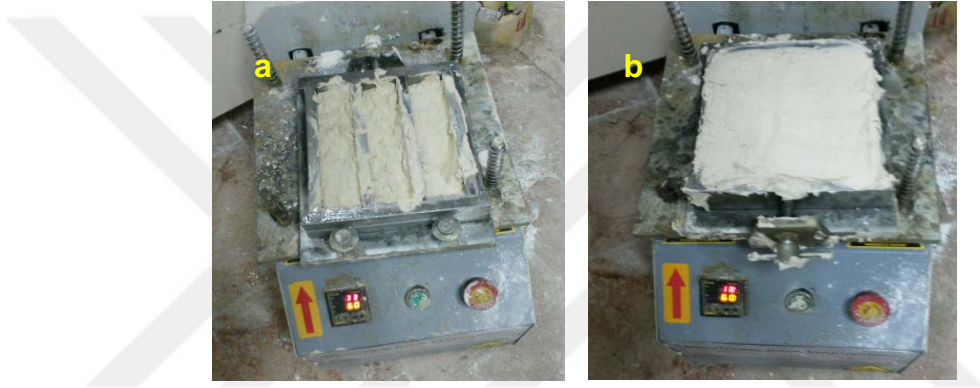
Şekil 3.12 a) Kalıpların yarıya kadar doldurulması b) Kalıpların tamamının doldurulması
