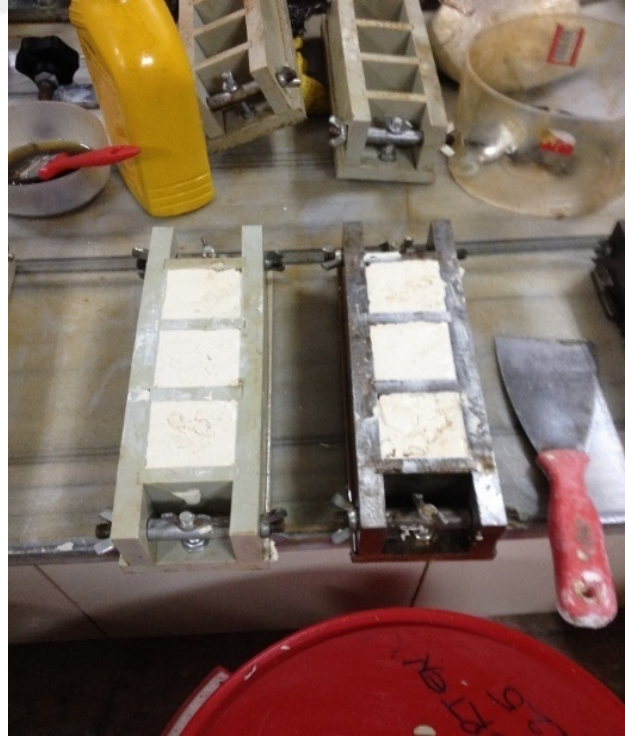
Şekil A.8: Numunelere Master İşleminin Yapılması
