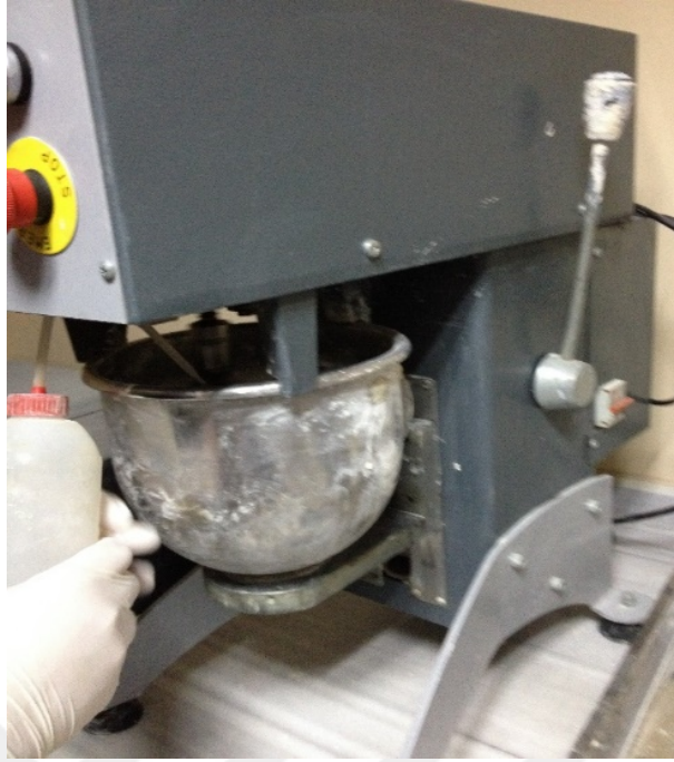
Şekil A.5: 5 mol NaOH'ın Piset ile Miksere Konulması
