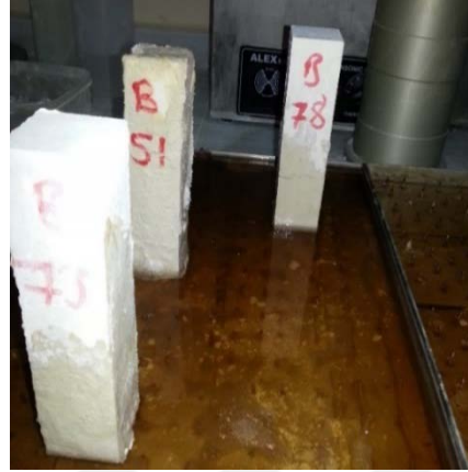
Şekil 3.8 7 ve 28 günlük kapiler su emme deneyi
