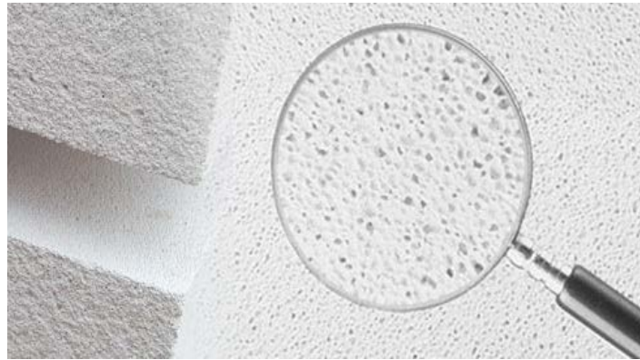
Şekil 2.9 Gazbeton Gözenekli yapısı (Ytong,2016)
