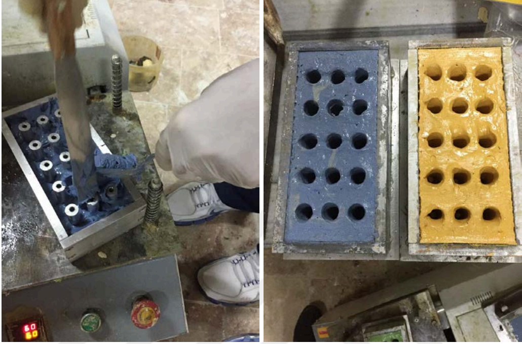
Şekil B.1: Renk tozu katılmış geopolimer hamurun kalıplar dökümü
