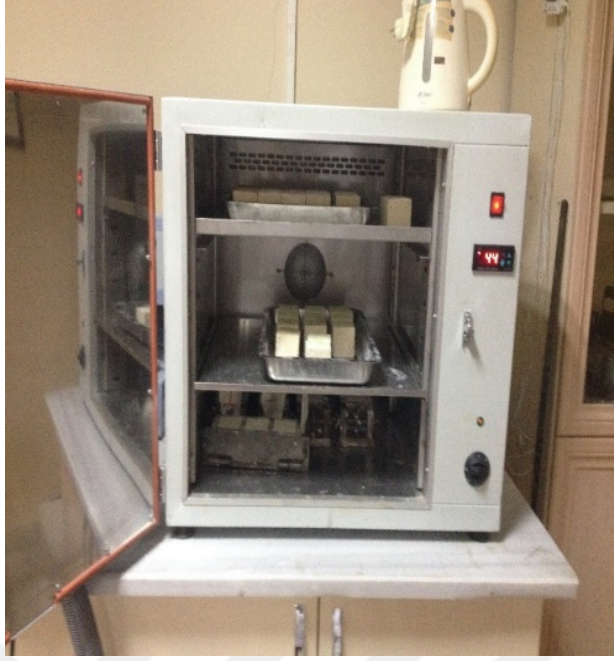
Şekil A.12: 45°C Etüvde 24 Saat Kür İşlemine Tutulan Numuneler
