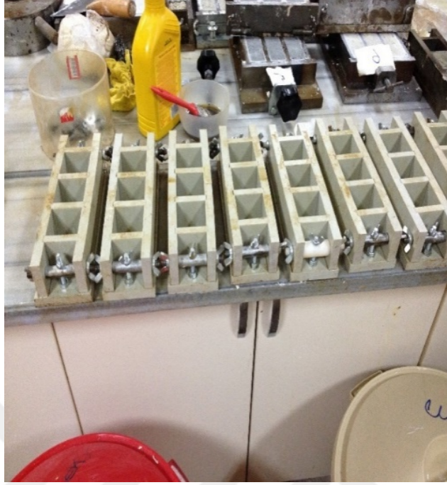
Şekil A.7: Kalıpların Yağlanması İşlemi
