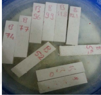
Şekil 3.14 7 ve 28 günlük su emme deneyi
