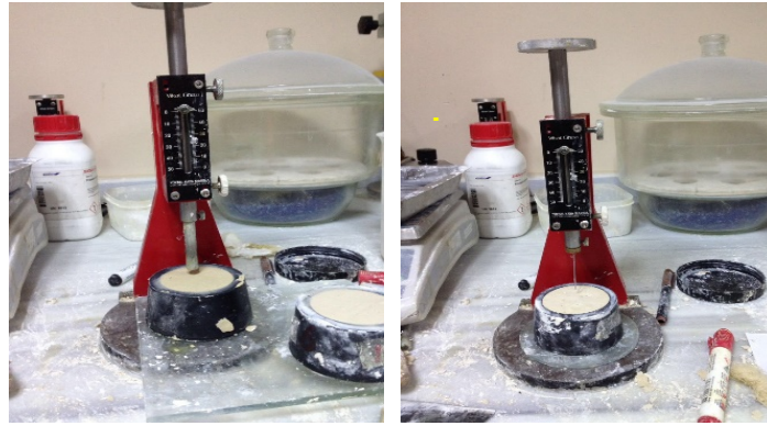
Şekil 3.11 a) Vicat cihazında kıvam belirlenmesi b) Priz başlangıcı ve priz sonu belirlenmesi
