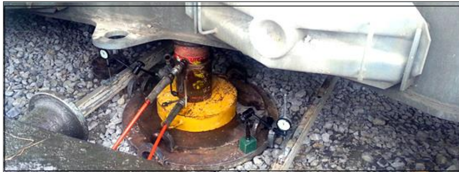
Şekil 1.19 Taş kolon yükleme deneyi (URL8)
