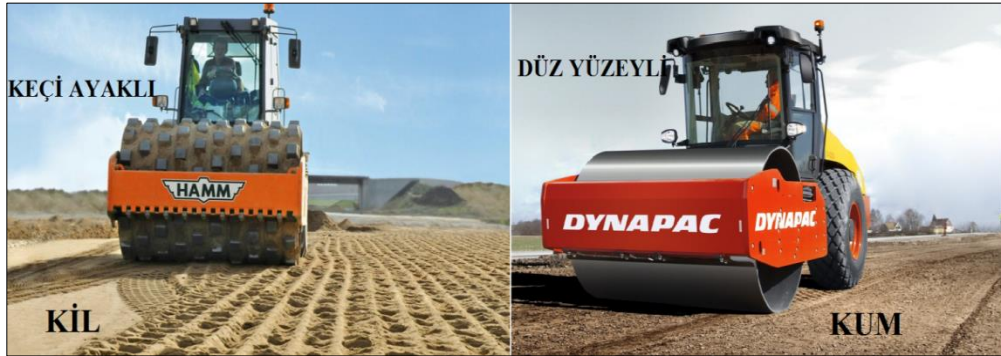
Şekil 1.3 Zemin cinslerine göre kullanılan silindir tipleri
