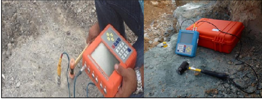
Şekil 1.53 Kazık süreklilik deneyi
