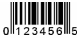
Şekil.10. UPC-E Barkod Örneği (Kaynak: Barkod Nedir, Anonim, b.t.).
