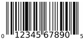
Şekil.9. UPC-A Barkod Örneği (Kaynak: Barkod Nedir, Anonim, b.t.).
