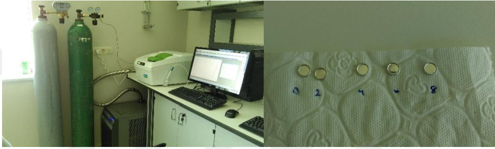
Şekil 2.5 DSC cihazı ve analizde kullanılan numuneler
