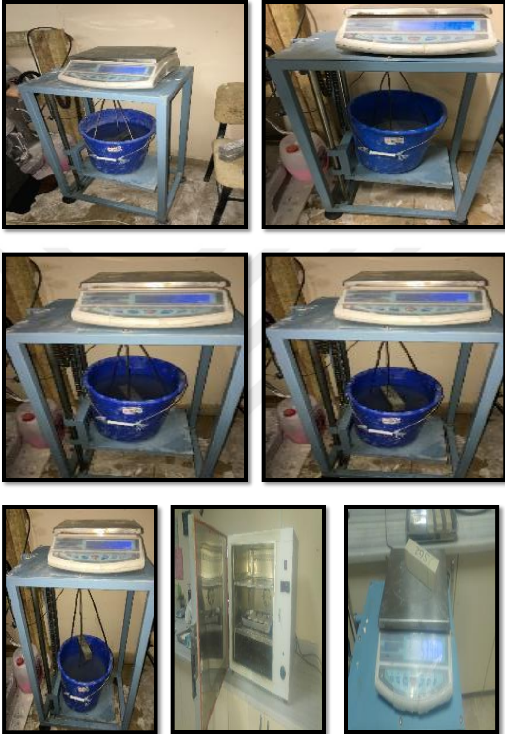
Şekil 7.7 Su emme deneyi
