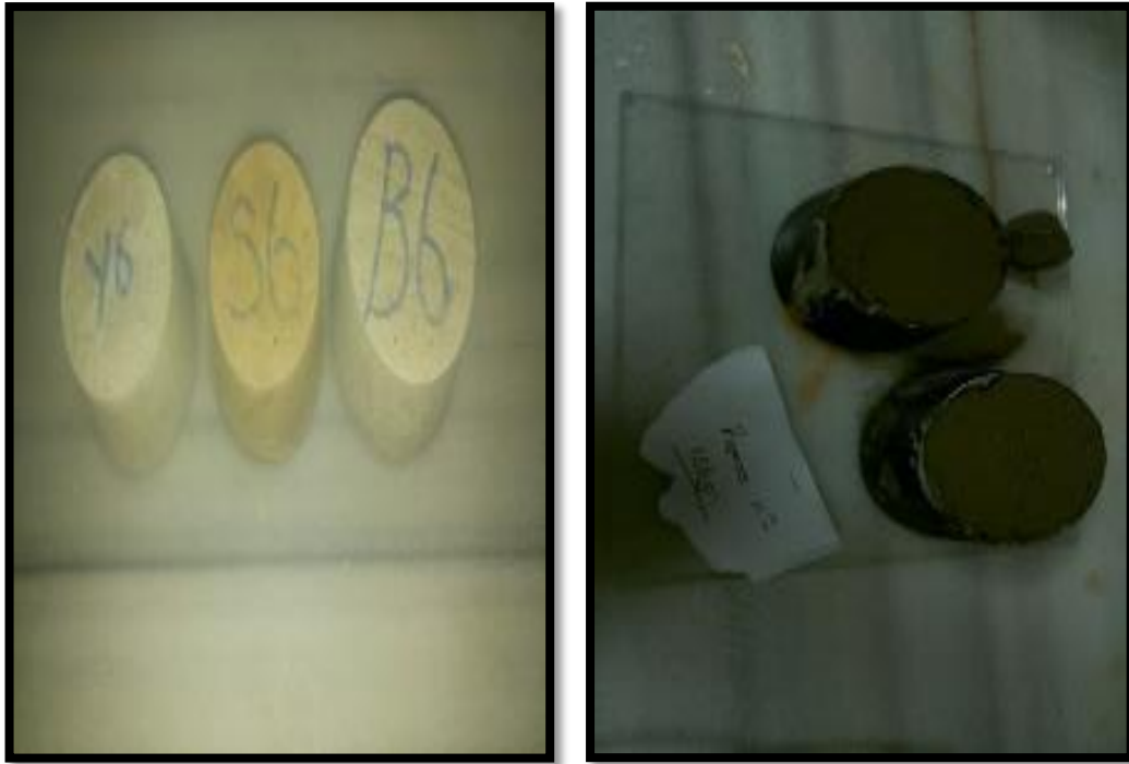
Şekil 6.4 Bayburt Taşı ikameli çimento hamurları- Referans çimento hamuru
