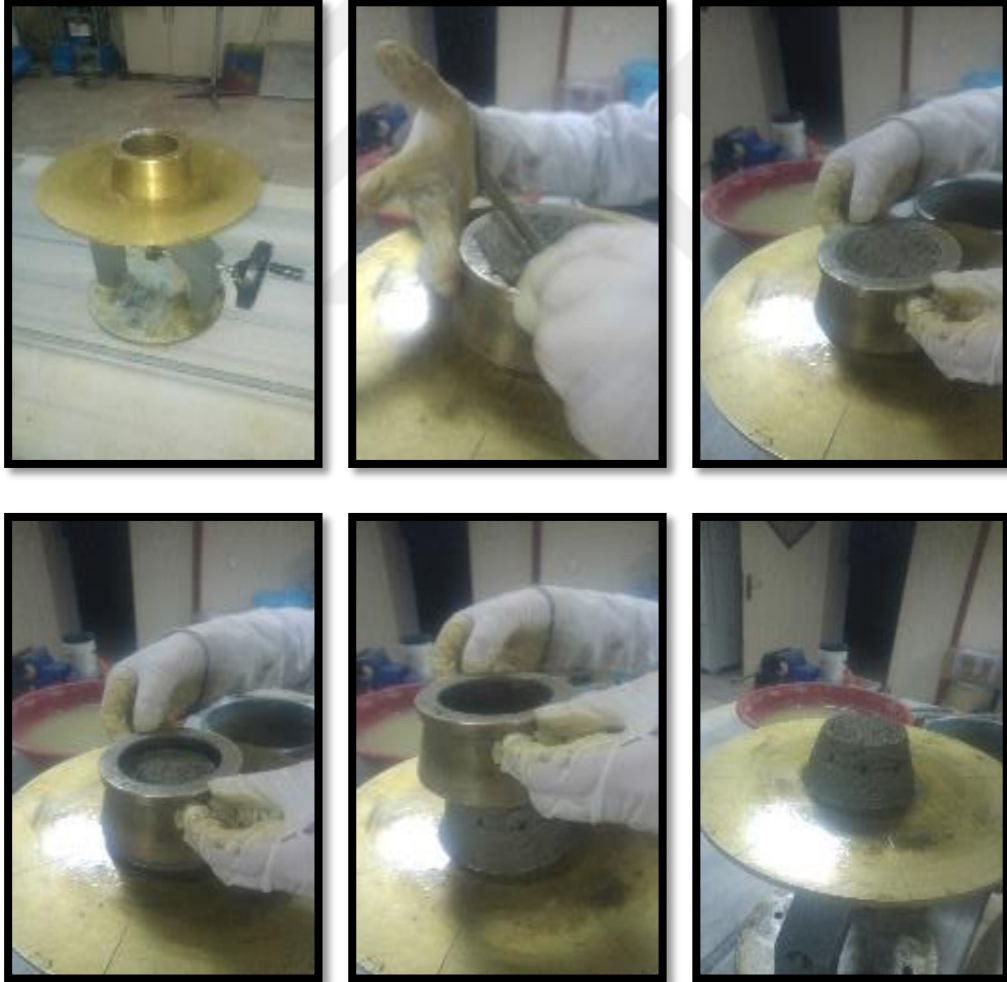
Şekil 7.5 Yayılma Tablası Deneyi
