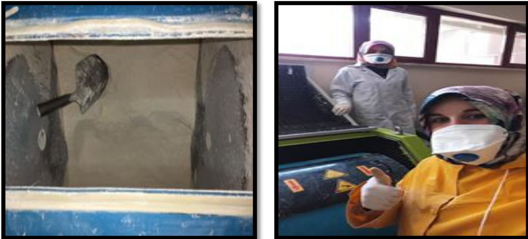
Şekil 3.2 Bayburt Beyaz Taşının öğütülmesi
