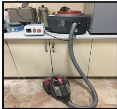
Şekil 1.5 Öğütme sonrası malzeme eleme düzeneği
