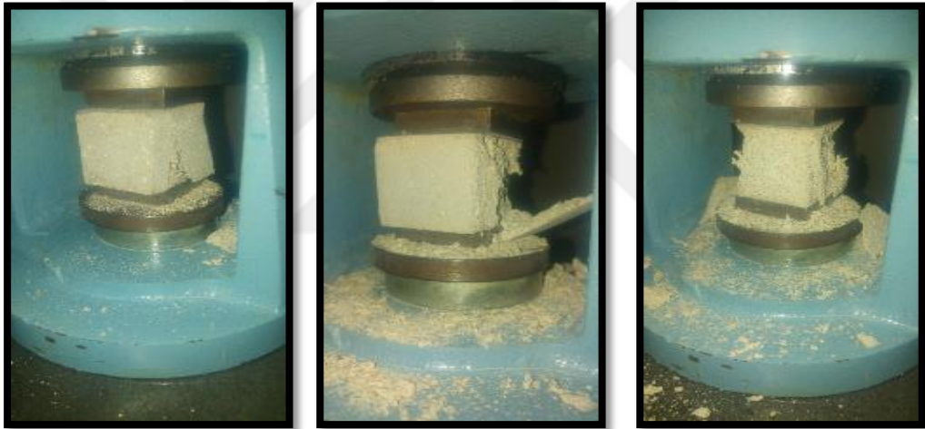
Şekil 9.2 Yüksek sıcaklık sonrası ( 300 °C ) basınç dayanımları
