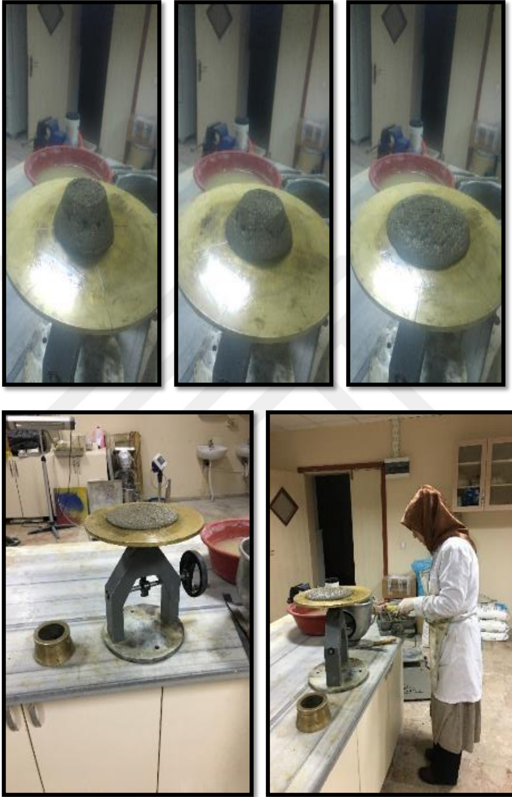
Şekil 7.6 Yayılma Tablası Deneyi
