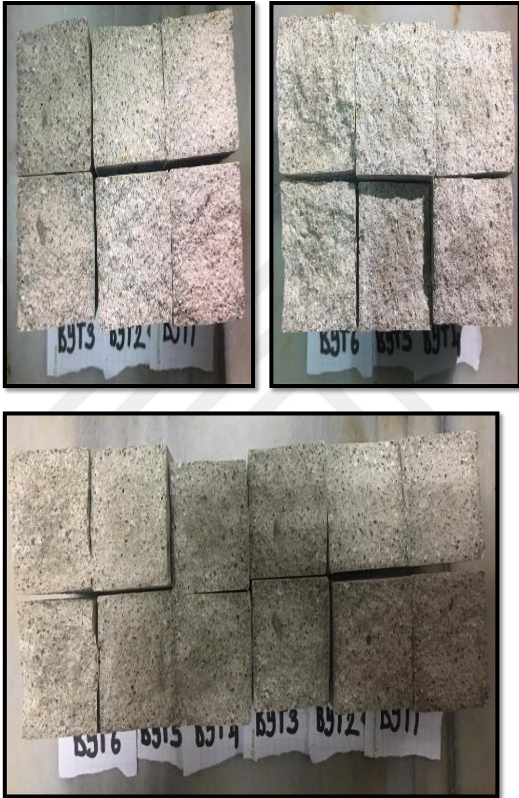
Şekil 7.11 Eğilme dayanımı deneyi sonrası BYT ikameli harç numunelerinin görüntüsü
