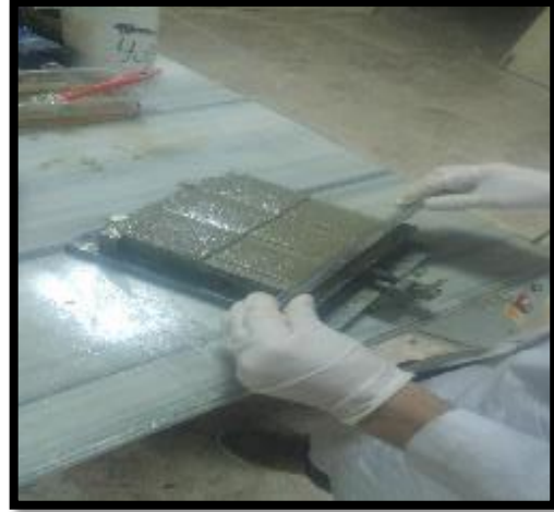
Şekil 7.1 Harçların kalıba yerleştirilmesi
