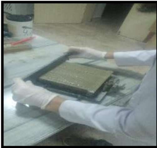
Şekil 7.2 Kalıpların tesviye edilmesi
