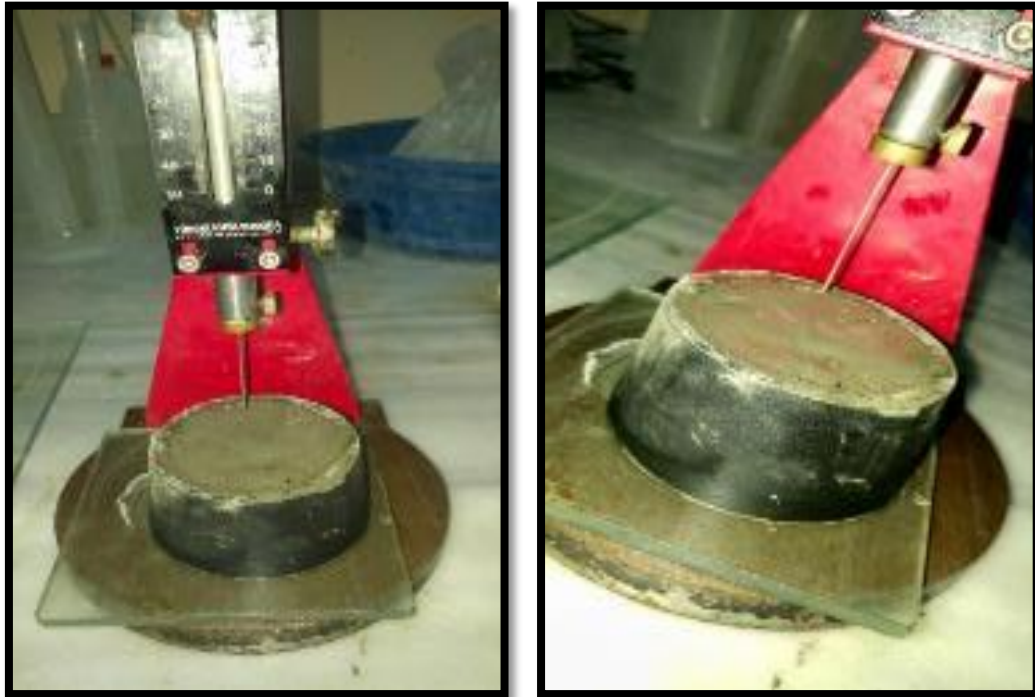
Şekil 6.5 Priz başlangıç ve sonu deneyleri
