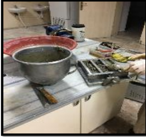
Şekil 7.1 Harçların kalıba yerleştirilmesi
