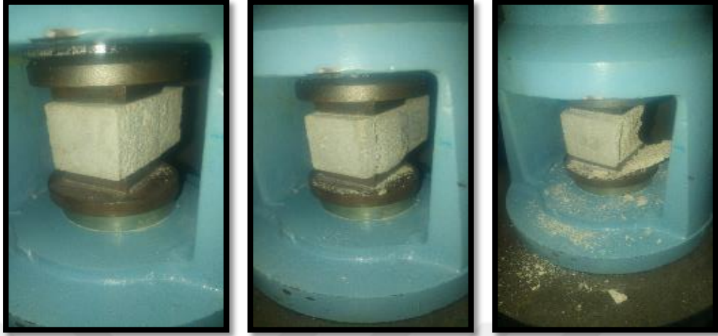
Şekil 9.1 Yüksek sıcaklık sonrası ( 100 °C ) basınç dayanımları
