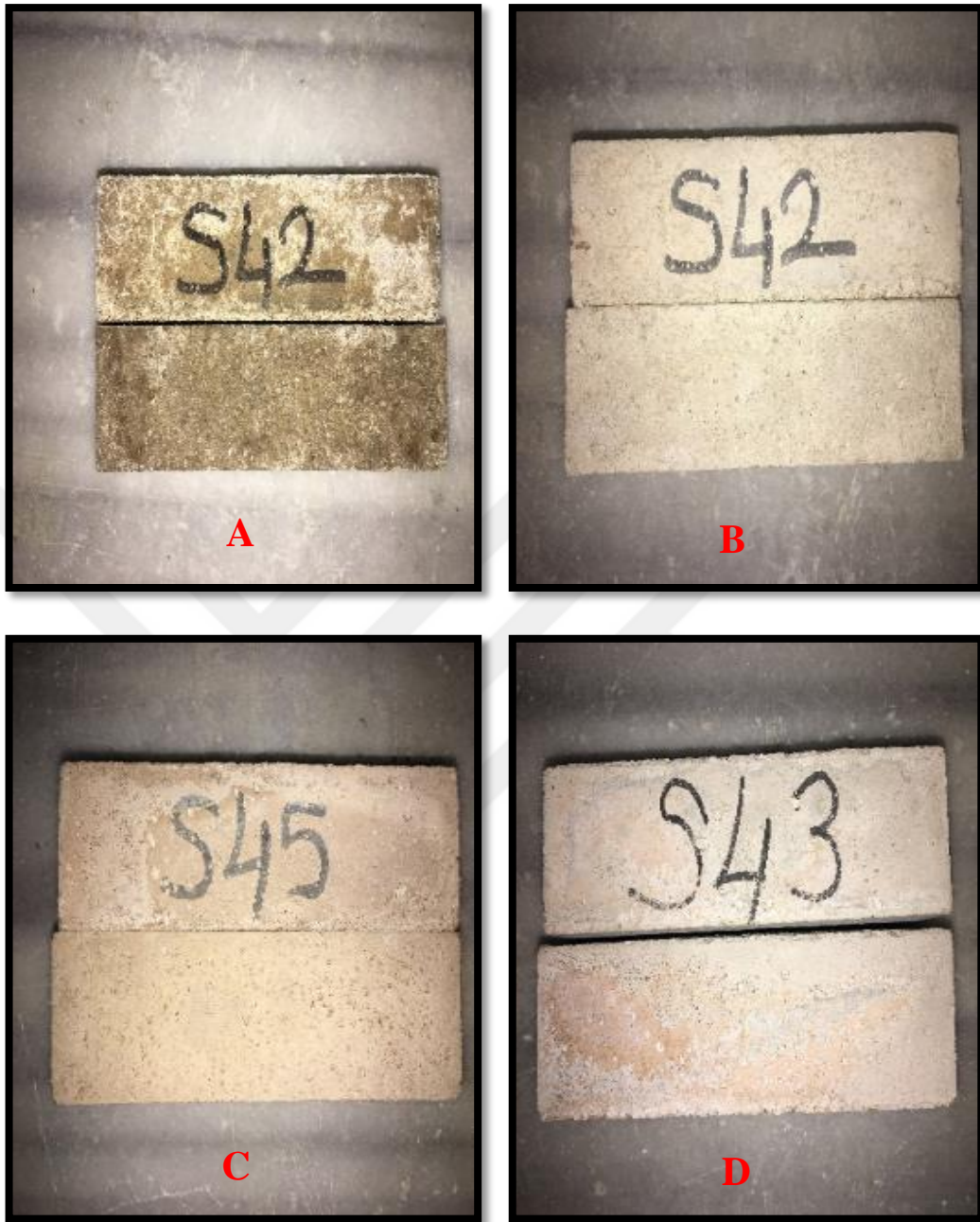
Şekil 11.3 Yüksek sıcaklık sonrası BST ikameli çimento harçlarının renk değişimleri A (20 °C), B (100 °C), C (300 °C), D (700 °C)
