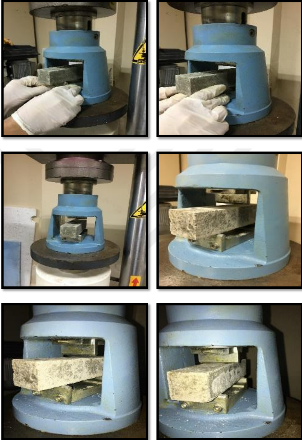
Şekil 7.8 Eğilme dayanımı deneyleri
