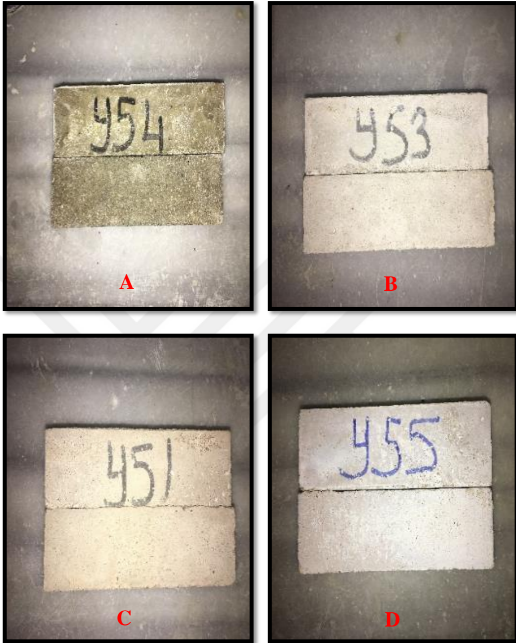
Şekil 11.2 Yüksek sıcaklık sonrası BYT ikameli çimento harçlarının renk değişimleri A (20 °C), B (100 °C), C (300 °C), D (700 °C)
