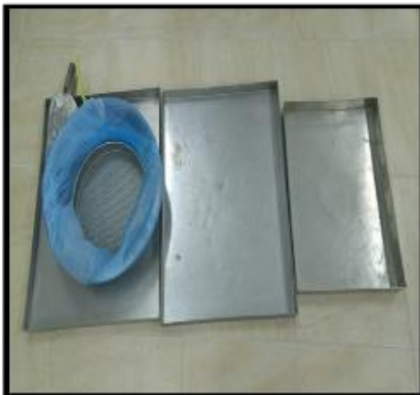
Şekil 1.5 Öğütme sonrası malzeme eleme düzeneği
