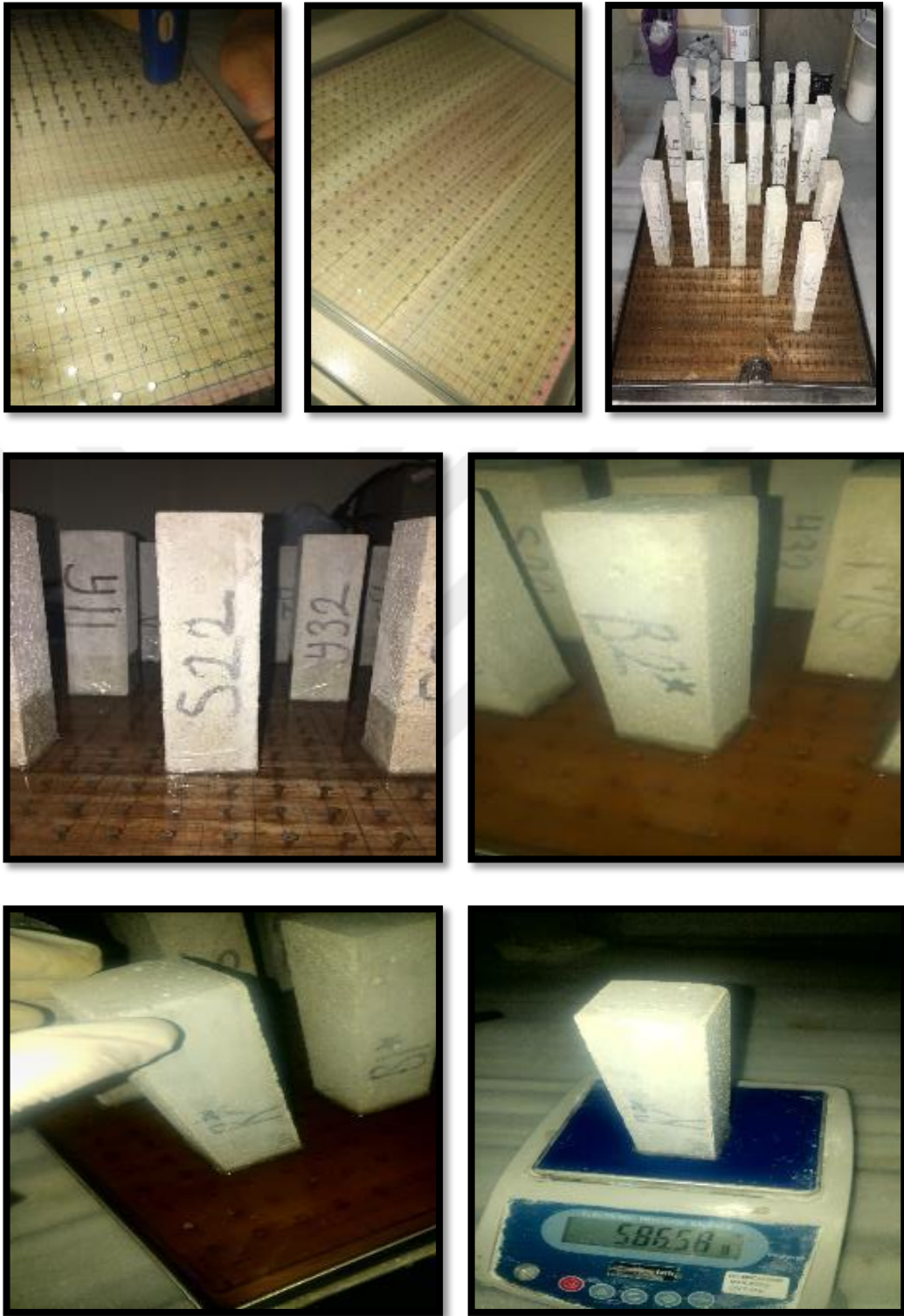
Şekil 7.13 Kapiler su emme düzeneği ve deneyleri
