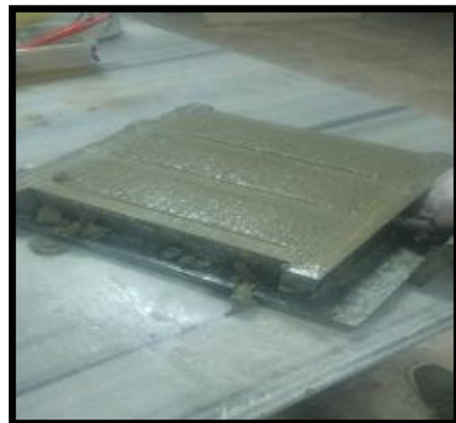
Şekil 7.2 Kalıpların tesviye edilmesi
