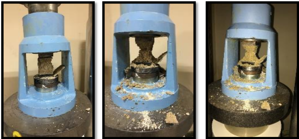
Şekil 9.3 Yüksek sıcaklık sonrası ( 700 °C ) basınç dayanımları
