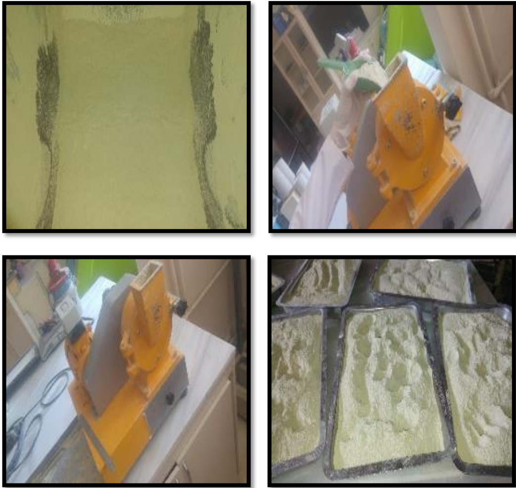
Şekil 4.2 Bayburt Yeşil Taşının öğütülmesi
