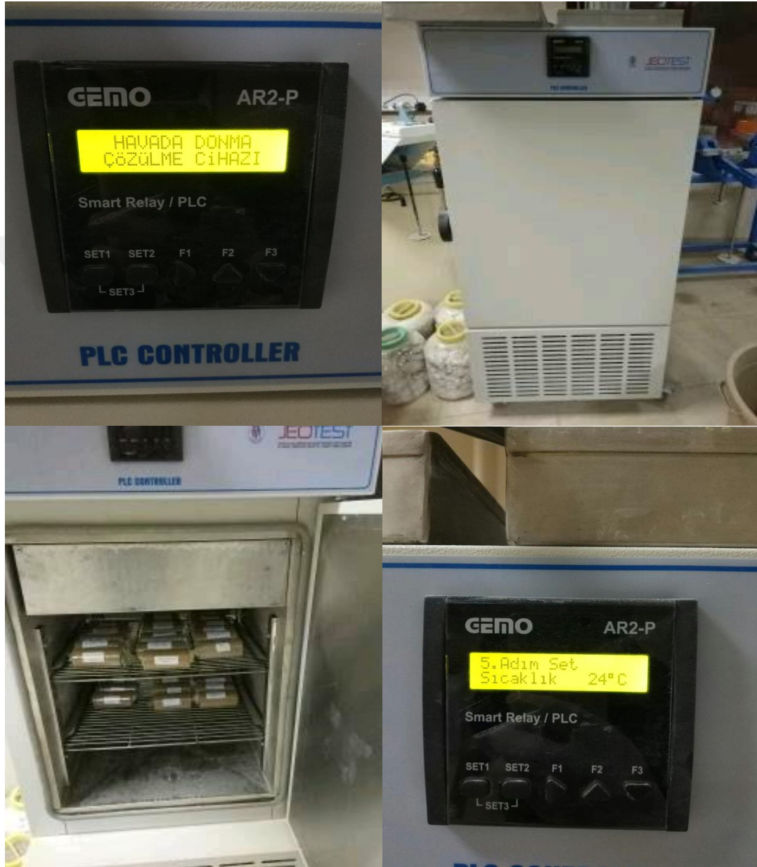
Şekil 3.10 Havada donma-çözülme cihazı ve donma-çözülme deney düzeneği
