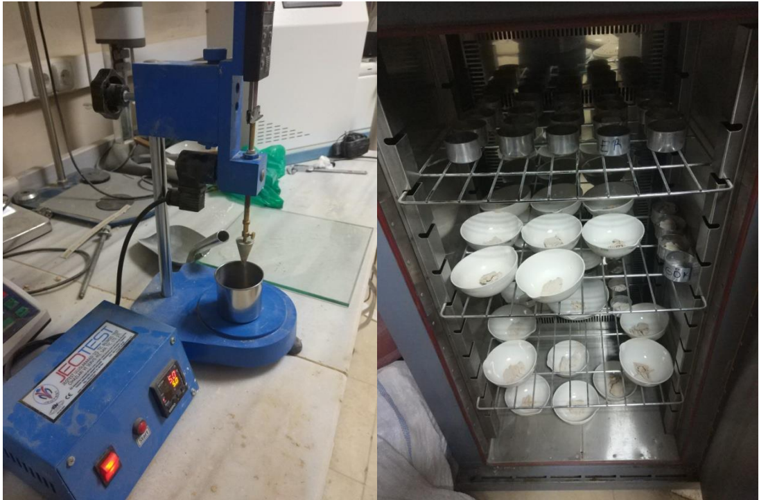
Şekil 3.5 Koni penetrasyon cihazı ve etüve koyulan numuneler
