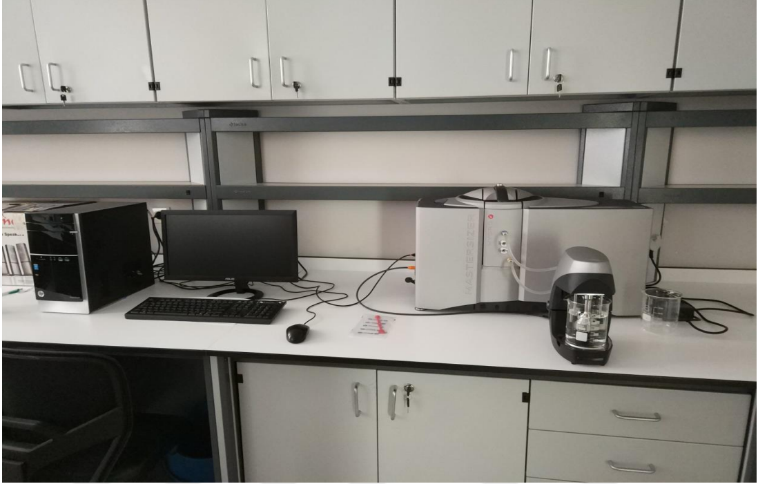
Şekil 3.2 Mastersizer Hydro 3000 lazer kırınım cihazı
