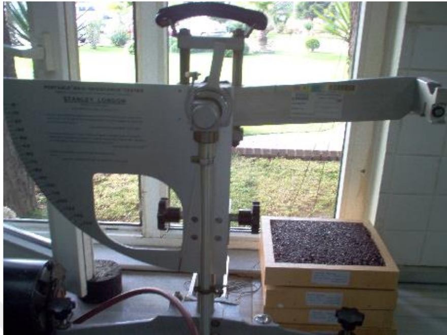
Şekil 2.23 Kayma direnci ölçme cihazı (Seçginli, 2007)
