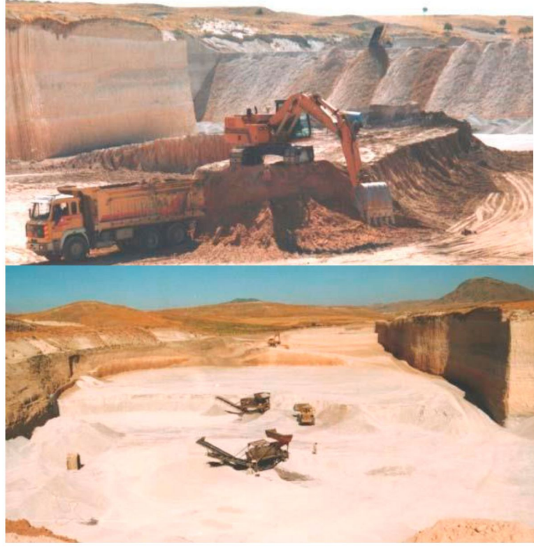
Şekil 2.8 Pomza hammaddesinin ocaktan üretilmesi (StephenBlock Machine Company, 2015)
