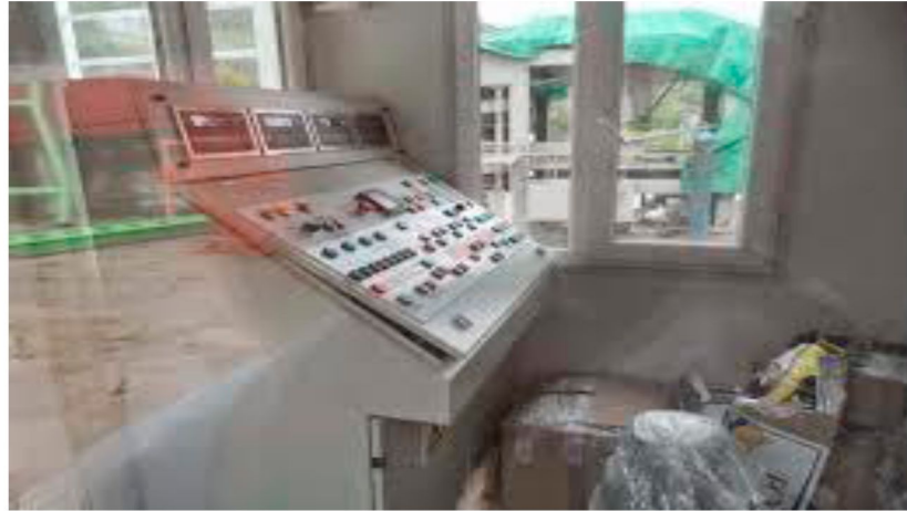
Şekil 3.9 Bimsblok üretiminde bilgisayar otomasyonu (Nur Makine A. Ş, 2015)
