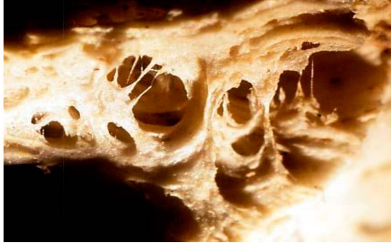
Őekil 2.6 Pomza agregası rneđinin poroz yapısının grnm (scan elektron mikroskop ile) (Őener,1999)
