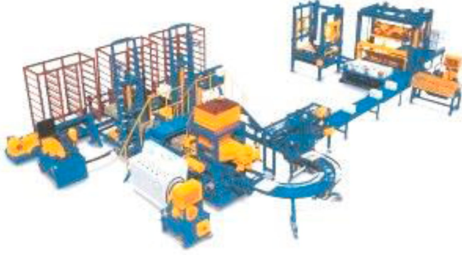
Şekil 3.2 Yarı otomasyonlu Bimsblok üretim sistemi sembolik görünümü (Türkiye Odalar ve Borsalar Birliği, 2006)
