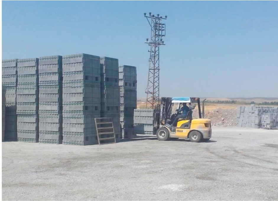
Şekil 3.7 Bims bloklarının raflara yerleştirilmesi (www.idomac.com, 2017)
