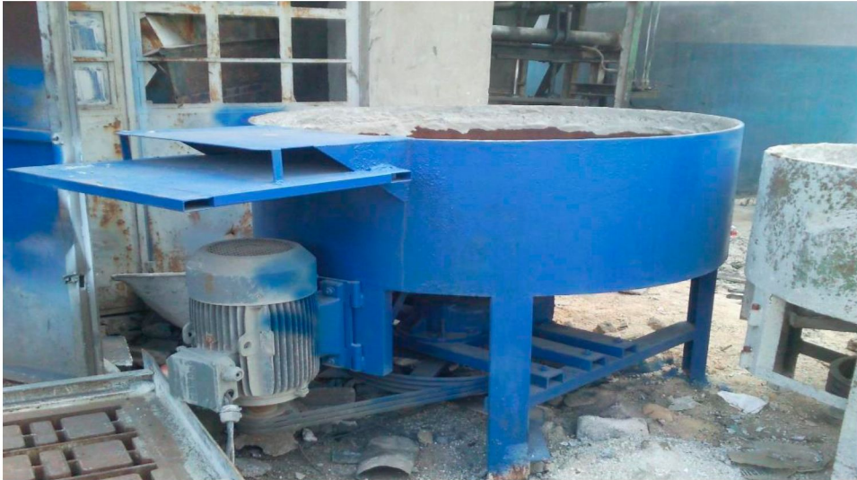
Şekil 3.5 Bims mikser karışım aşaması (Nur Makine A. Ş, 2015)
