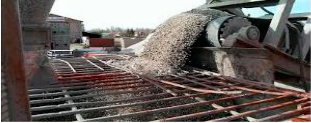
Şekil 3.4 Agregası haline dönüştürülmüş pomza (www.idomac.com, 2017)
