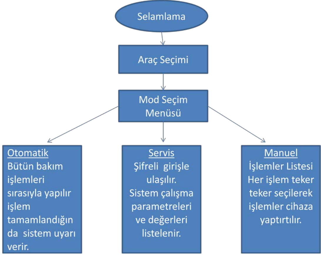
Şekil 4.1 Yazılım Arayüz Çalışma Diagramı
