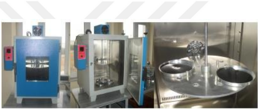
Şekil 1.10. TFOT deney aleti (Yılmaz,2016)
