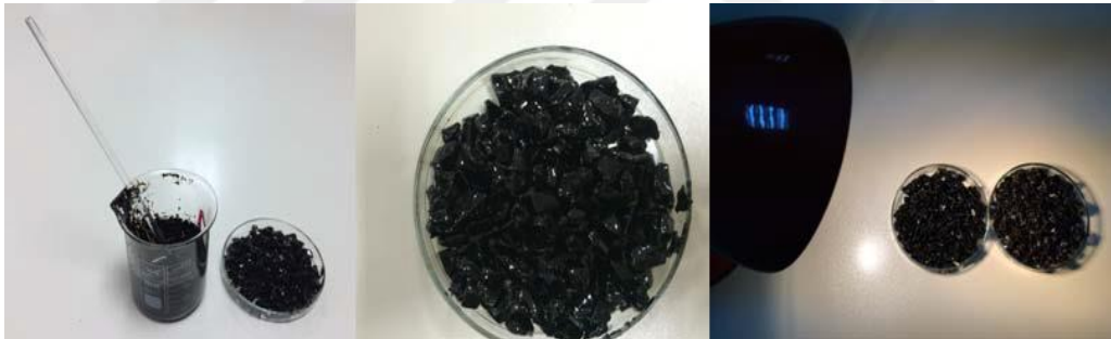
Şekil 1.13. Nicholson Soyulma Deneyi
