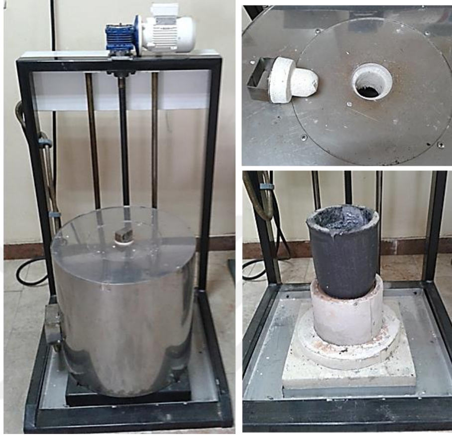
Şekil 3.4. Çan tip elektrik direnç ertitme ocağı
