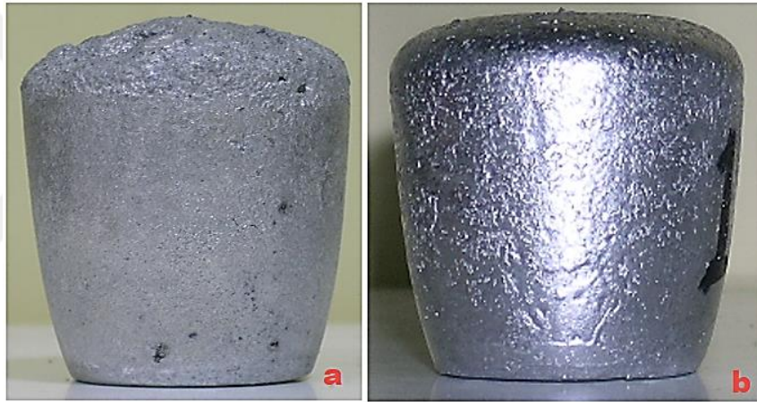
Şekil 4.1. RPT test numunesi görüntü resimleri; a) gaz giderme işlemi öncesi, b) gaz giderme işlemi sonrası
