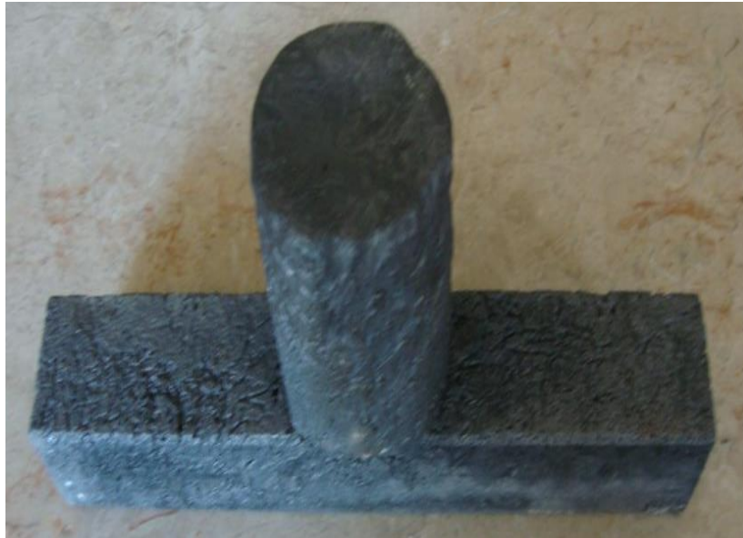
Şekil 3.7 Döküm sonrası kalıptan çıkmış 50 x 50 x 300 mm ebatlarındaki B iş parçası görüntüsü
