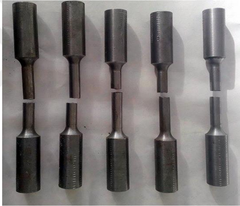
Şekil 4.1 Çekme testi sonucu numunelerin kırılma görüntüsü
