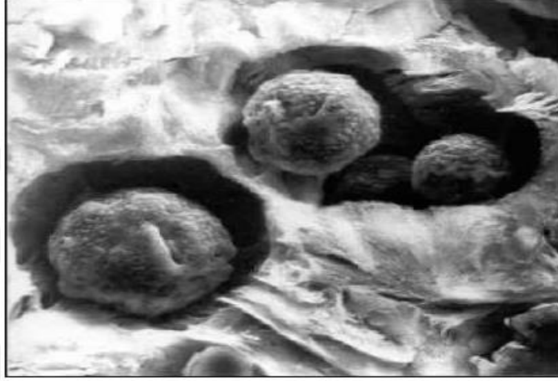
Şekil 2.15 Perlitik küresel grafitli dökme demir büyütme: 600x (20 \mu\text{m} ) (Imasogie ve Wendt, 2004)
