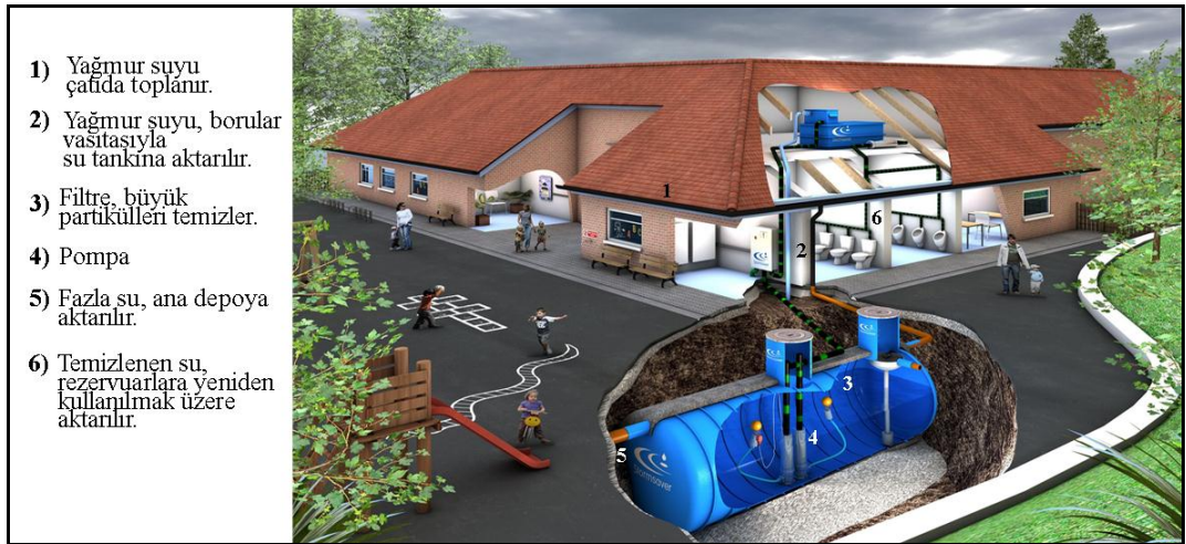
Şekil 48: Yağmur Suyunun Binada Kullanımı [115]
