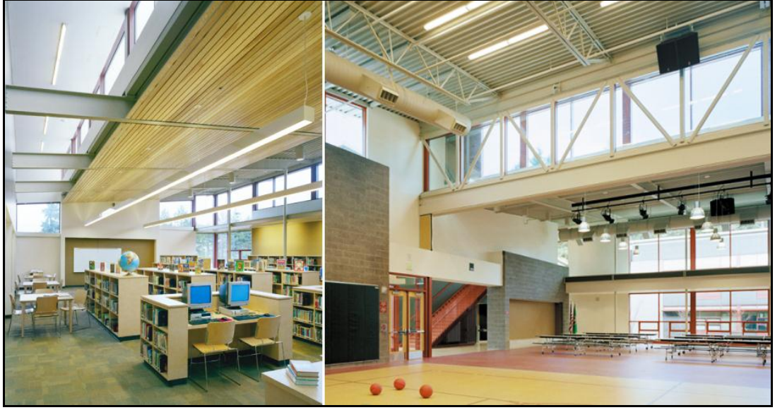
Şekil 77: Güneş Işığının Tepe Pencerelerinden İç Mekana Geçişi Ben Franklin Okulu [142]
