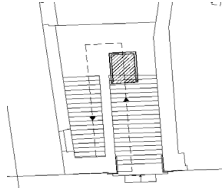
Şekil 4.2: Sosyal Aksiyon Binasına Yapılan Kaldırma Platformu
