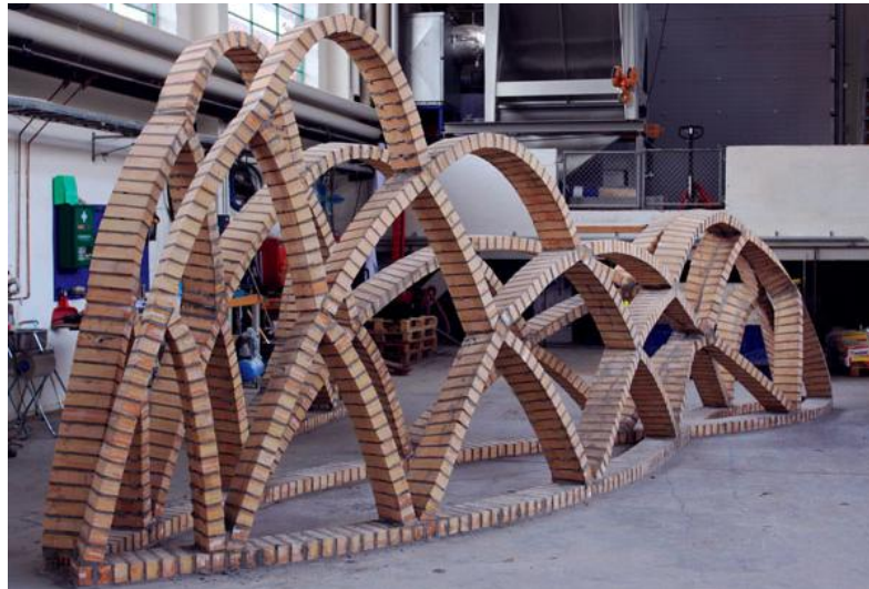
Şekil.51. Tuğladan İnşa Edilmiş Zincir Eğrisi Modeli
