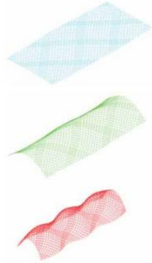
Şekil.36. Dinamik Rahatlama Simülasyonu
