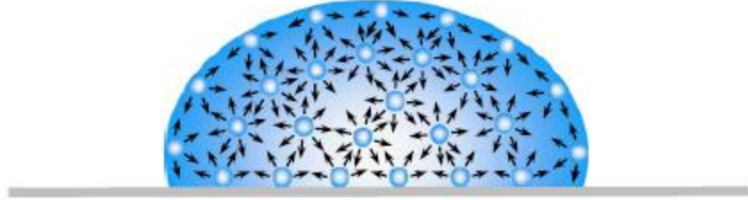
Şekil 2: Yüzey gerilimi yüzeydeki sıvı moleküllerinin dengede olmayan kuvvetleri tarafından oluşturulur
