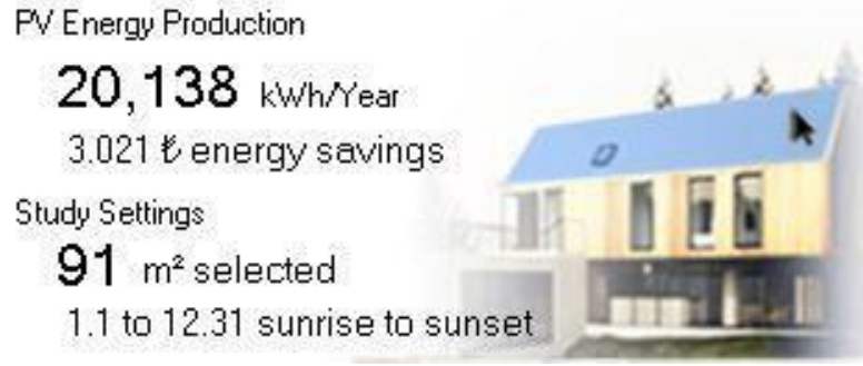
Şekil 46. 339 ada/ parsel üzerindeki güneş ışınımından çatıda PV kullanımıyla elde edilecek enerji üretimi
