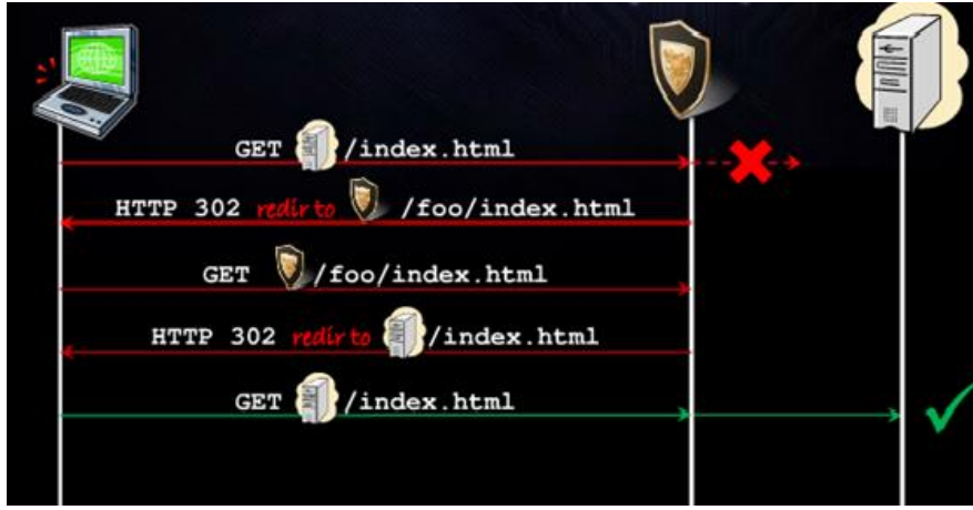
Şekil 33 : Http redirect yönteminin adımları.
