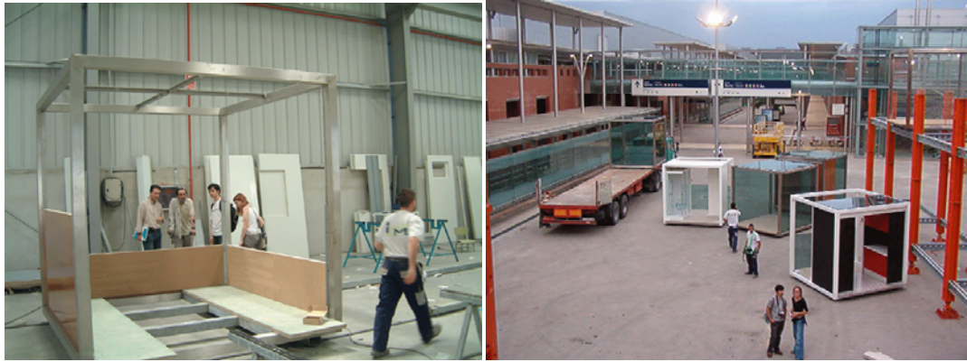
Şekil 4.81 Sipariş üzerine atölyede üretimi ve montaj ya da uygulama sahasına nakliyesi
