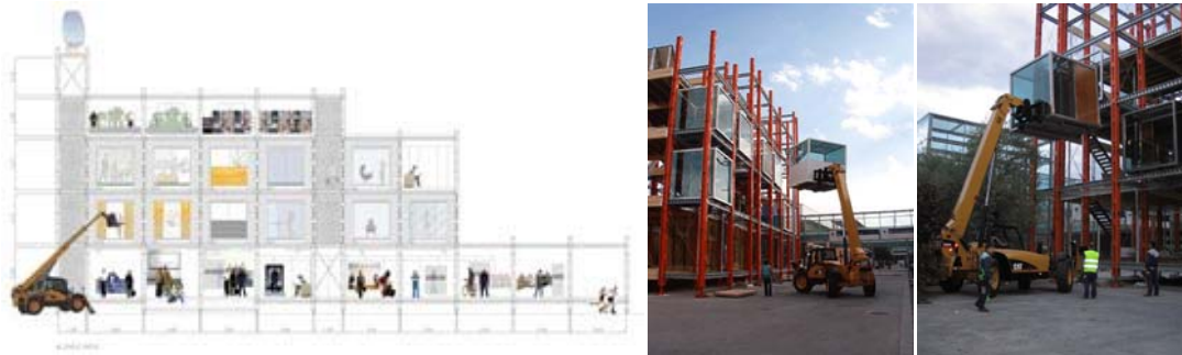
Şekil 4.82 Montaj ve Uygulama alanında modüler küplerin taşıyıcı iskelet sisteme yerleşimi ve ya modüllerin sistem içerisinde yer değişim şekilleri
