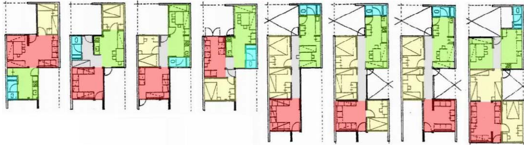
Şekil 2.16 Tung Song Hong Uygulaması B Tipi Çekirdek Konutun Yatayda Büyüme Alternatif Planları (Erata, 1998)
