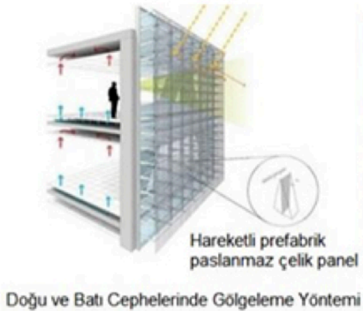
Resim 20 Doğu Batı ve Güney Cepheler İçin Dıştan Pasif Gölgeleme Yöntemleri [11]
