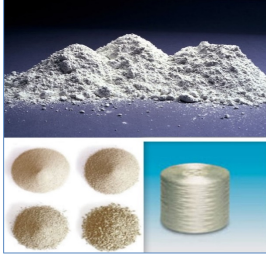
Şekil 2. 1. Karışımdaki silis kumu, Beyaz Çimento ve Cam Elyafi ( http://www.prekastas.com.tr )
