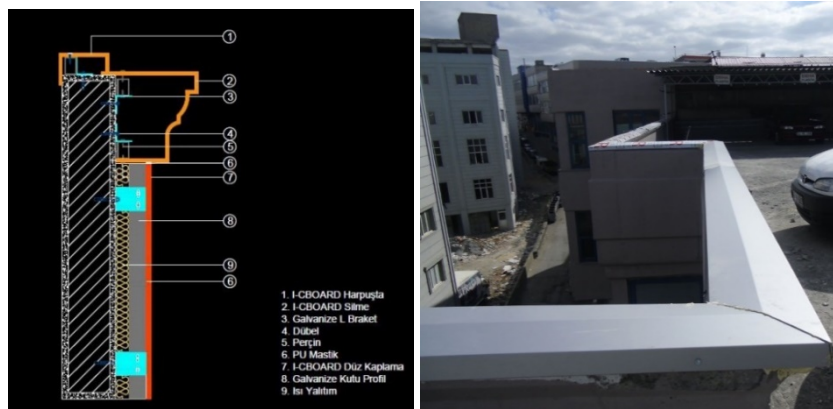
Şekil 2.66. Harpuşta Detay ve Uygulaması ( http://betonex.com.tr , 20.09.2015)
