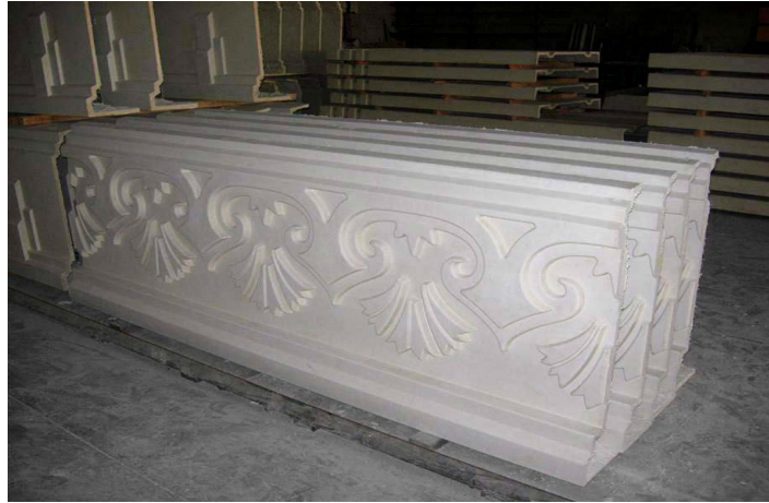
Şekil 2.61. Kat Ve Saçak Kuşakları İmalat Aşaması ( http://alcastone.com.tr ,15.09.2015)
