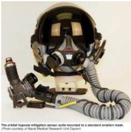
Şekil 6-10 NASA Tarafından Geliştirilen Hipoksi Tespit ve Uyarı Sistemi
