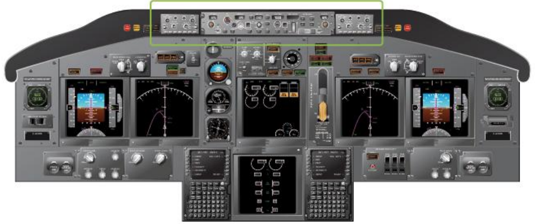
Şekil 3-59 AFDS Mod Kontrol Paneli
