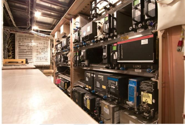
Şekil 2-2 Boeing 777 Elektronik Kompartıman ve LRU Yerleşimi
