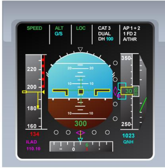
Şekil 3-20 Airbus Radyo Altimetre Gösterimi
