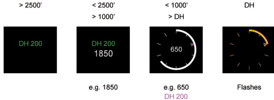
Şekil 3-17 Boeing EFIS EADI Radyoaltimetre Gösterimi
