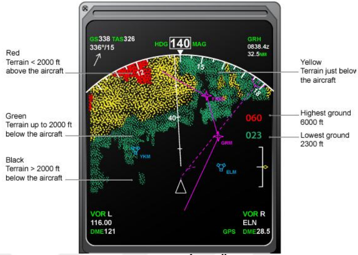
Şekil 4-23 2500 ft'teki Bir Uçak İçin Örnek Arazi Gösterimi
