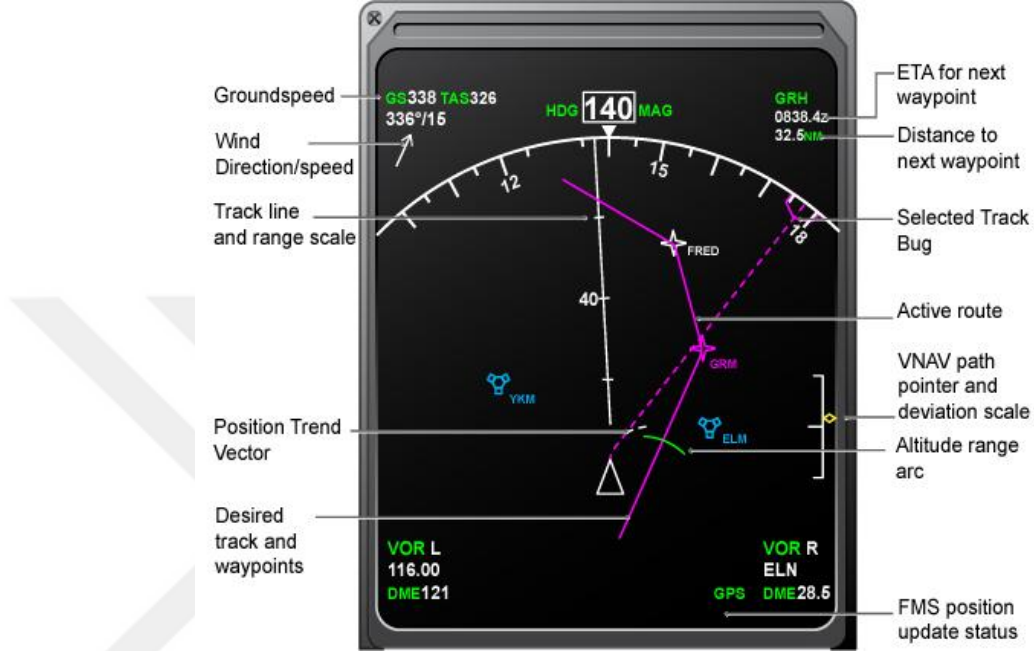
Şekil 3-33 EHSI Üzerinde Harita Gösterimi
