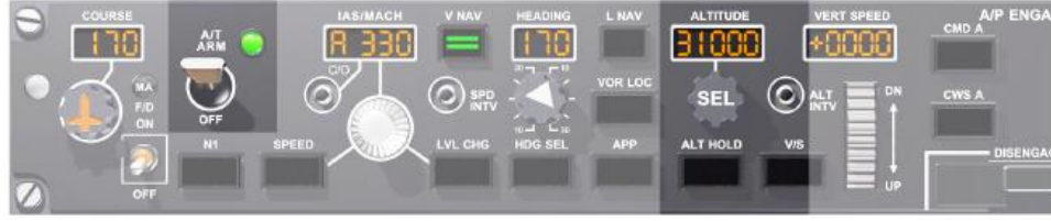
Şekil 3-68 Oto Throttle Devreye Alınmış Bir Uçağın Ayarlanmış İrtifaya İstenen Hızda Tırmanması
