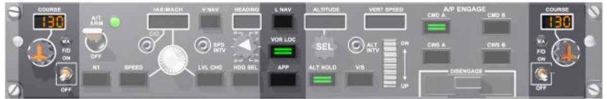
Şekil 3-79 VOR LOC Modu Seçilmesi ve Öncesinde Yaklaşma Açısının Seçilmesi
