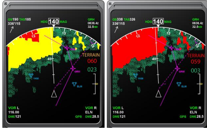
Şekil 4-24 40-60 Saniye İçin Aynı Arazideki Uçakların Farklı Hızlardaki EGPWS Gösterimleri
