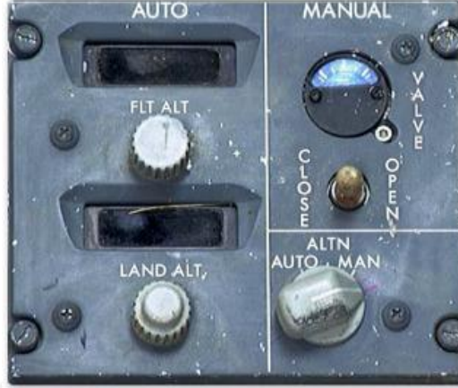
Şekil 6-4 Hellios 522 Numaralı Uçuş Enkazında Bulunan Basınç Kontrol Paneli Açıkça Manuel Konumda Olduğunu Göstermektedir
