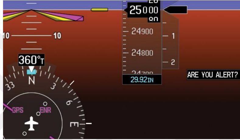
Şekil 6-6 PFD Hipoksi Alarm Ekranı
