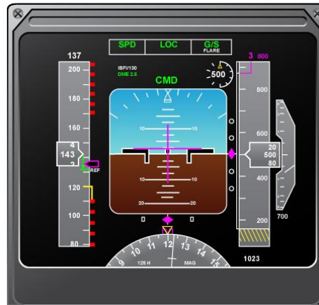
Şekil 3-65 ILS'in Yakalandığını Bildiren FMA ile PDF Ekranı
