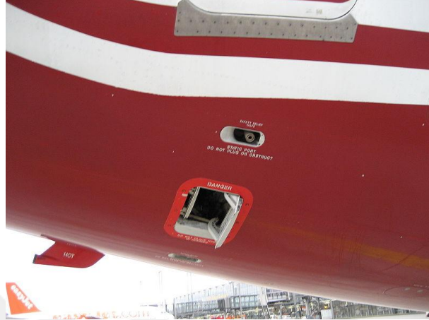
Şekil 6-5 Boeing 737-800 Çıkış Valfi Kabin Basıncını Düzenler
