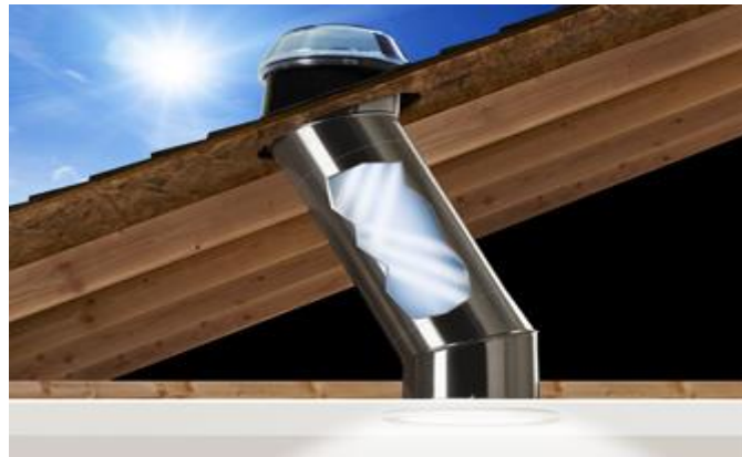
Şekil 31. Güneş tünellerinin iç mekâna etkisi ve kesit görünüşü
