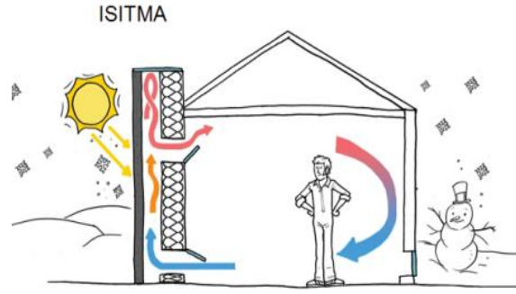
Şekil.10. Güneş Bacalarında Isıtma İlkesi (bernoullis-principle)
