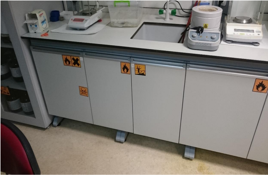
Şekil 6.12. Kimyasalların sınıflandırmadan sonra tezgah altlarının etiketleme ile depolanması
