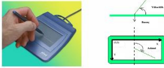
Şekil (3-7) Tipik Tablet Donanımı ve Verilerin Çıkarılması [6]
